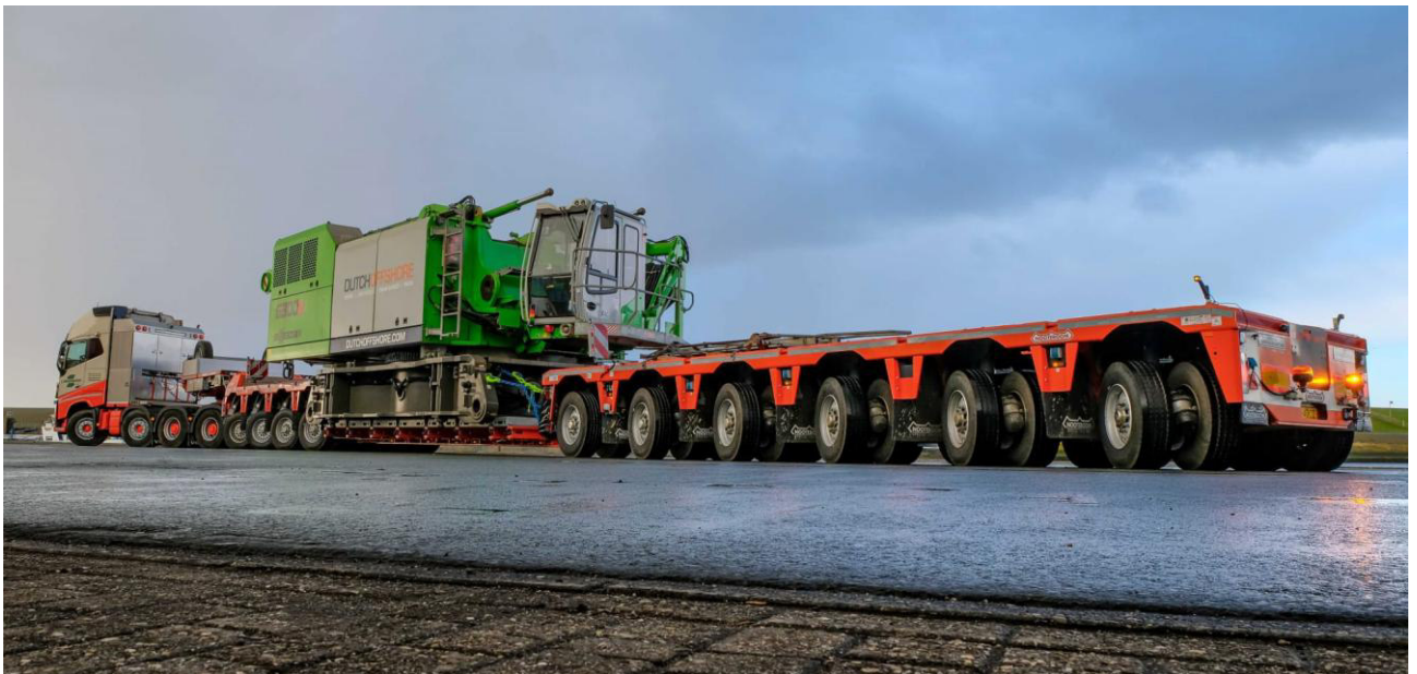
Рисунок 2.1 – Низькорамний трал із від’єднуваним гусаком (detachable gooseneck) класу Nooteboom EURO-PX (6-axle lines bogie)
