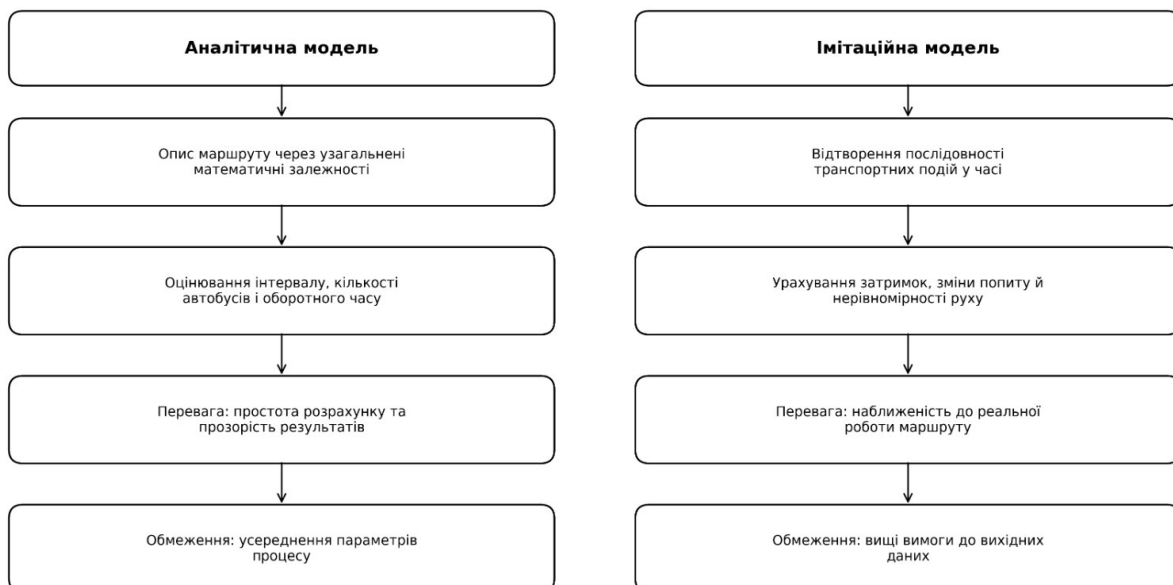
Рисунок 2.1 – Порівняння аналітичного та імітаційного підходів до моделювання автобусного маршруту
