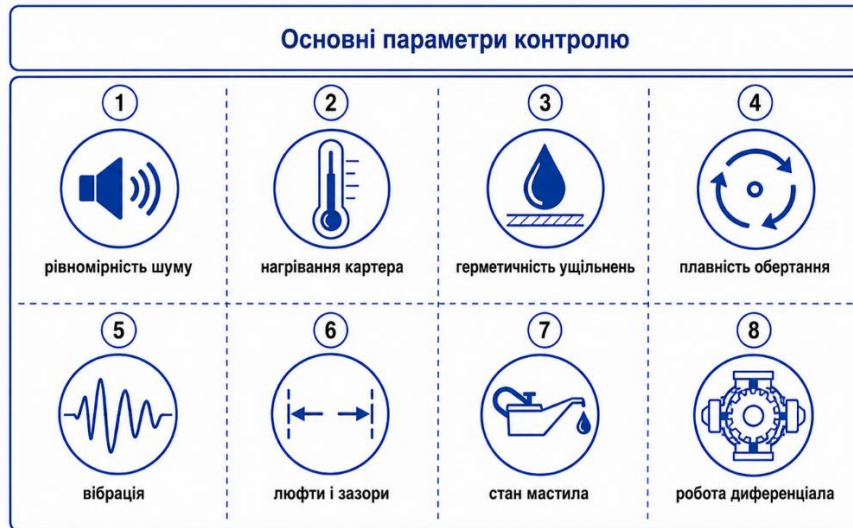
Рисунок 2.16 – Основні параметри контролю під час обкатування.
