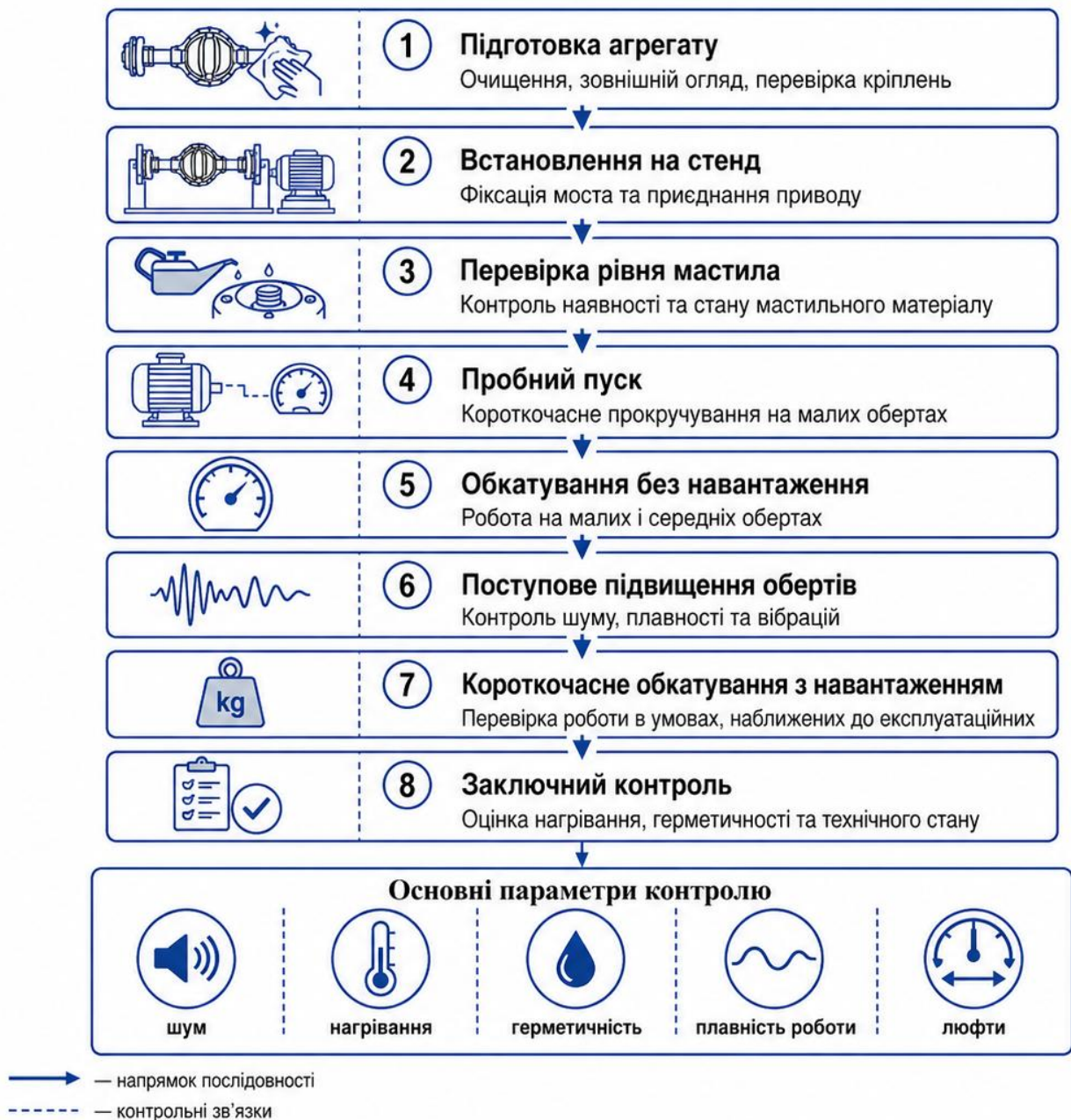
Рисунок 2.15 – Послідовність обкатування заднього моста.
