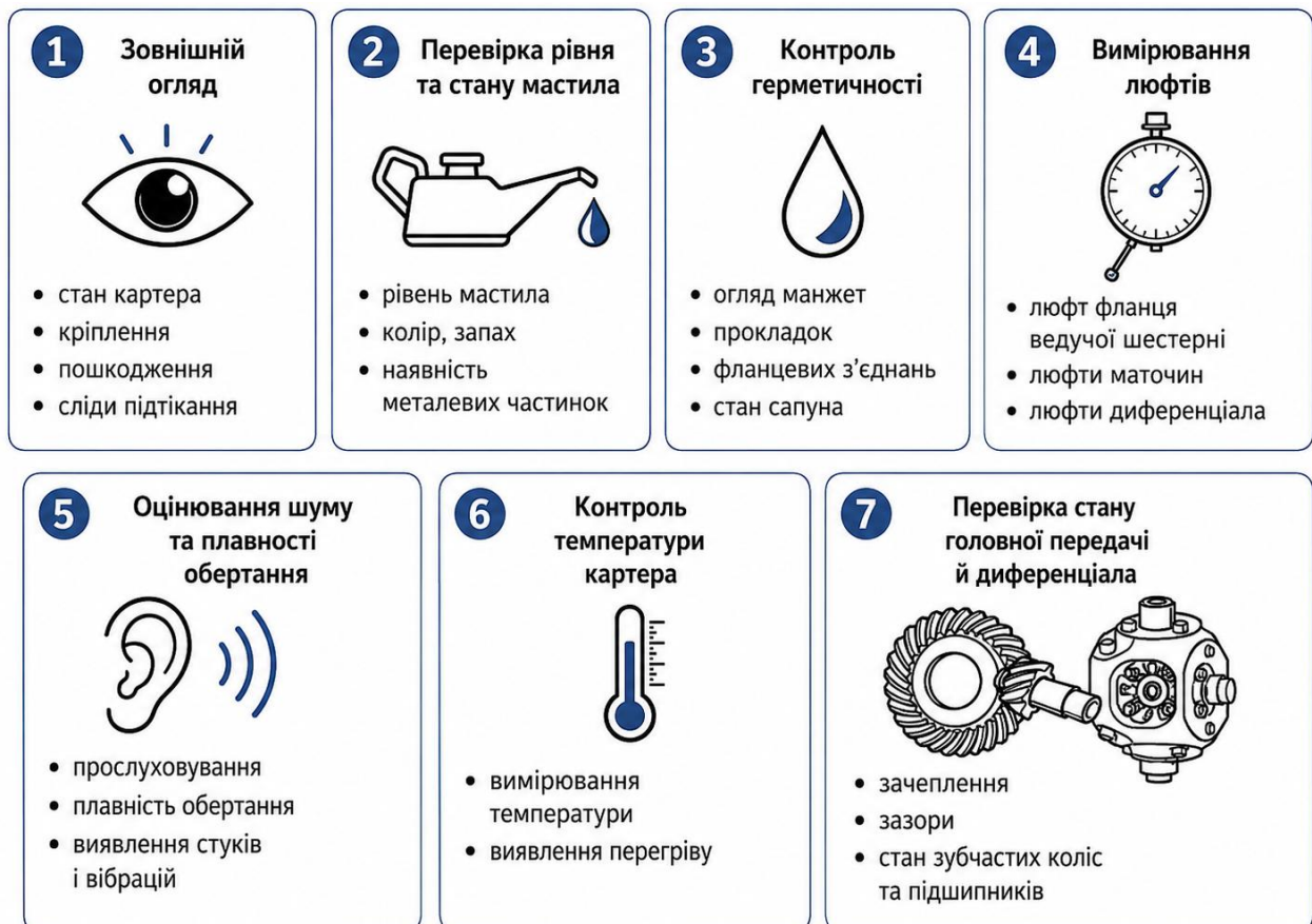
Рисунок 1.7 – Основні методи діагностування заднього моста.
