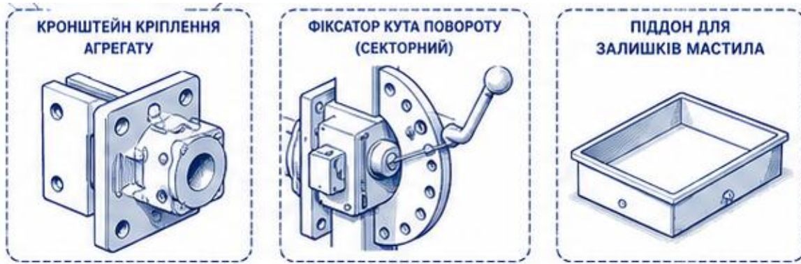
Рисунок 3.1 – Універсальне поворотно–фіксувальне пристосування для розбирання, складання та регулювання заднього моста автомобіля Iveco
