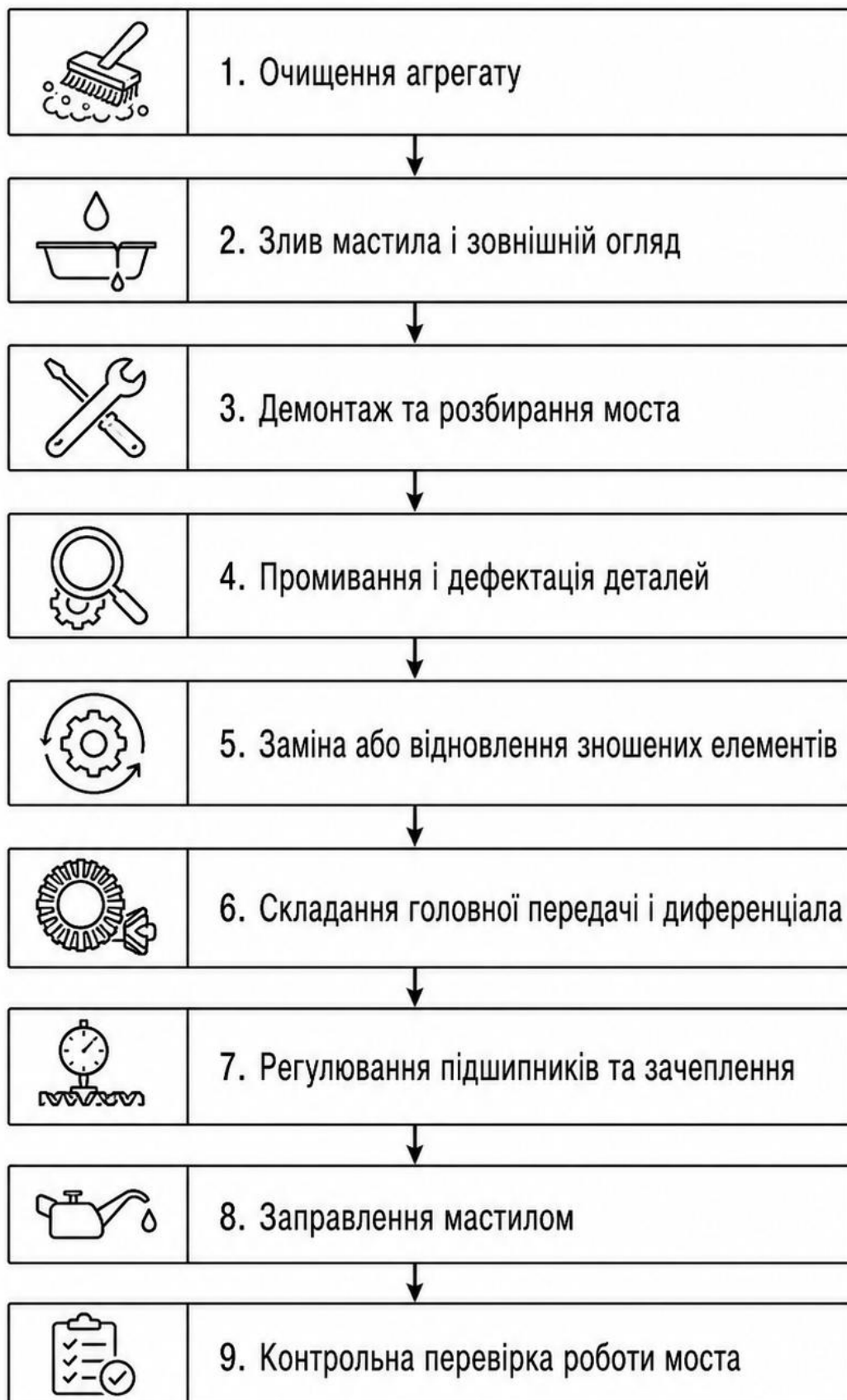
Рисунок 1.4 – Загальна схема технологічного процесу ремонту заднього моста.
