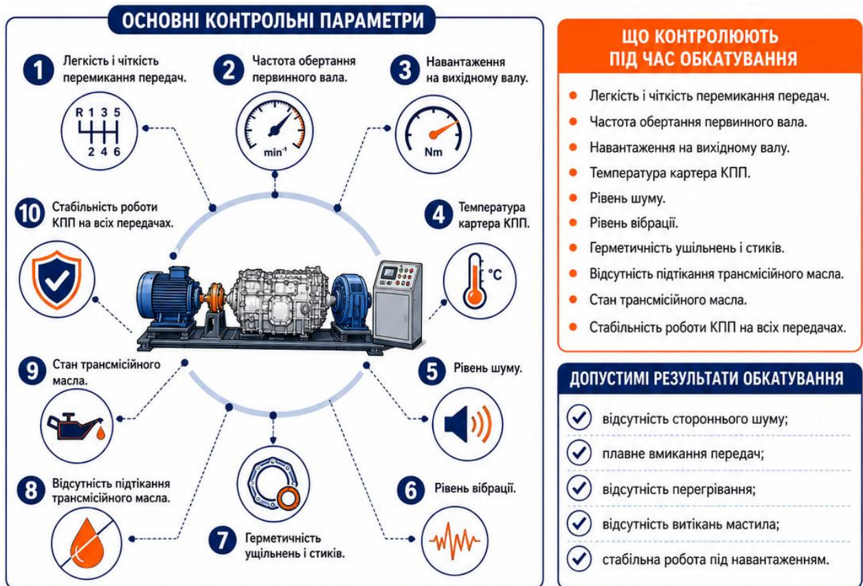
Рисунок 2.29 – Контрольні параметри під час обкатування коробки перемикавання передач ZF S 6.36.
