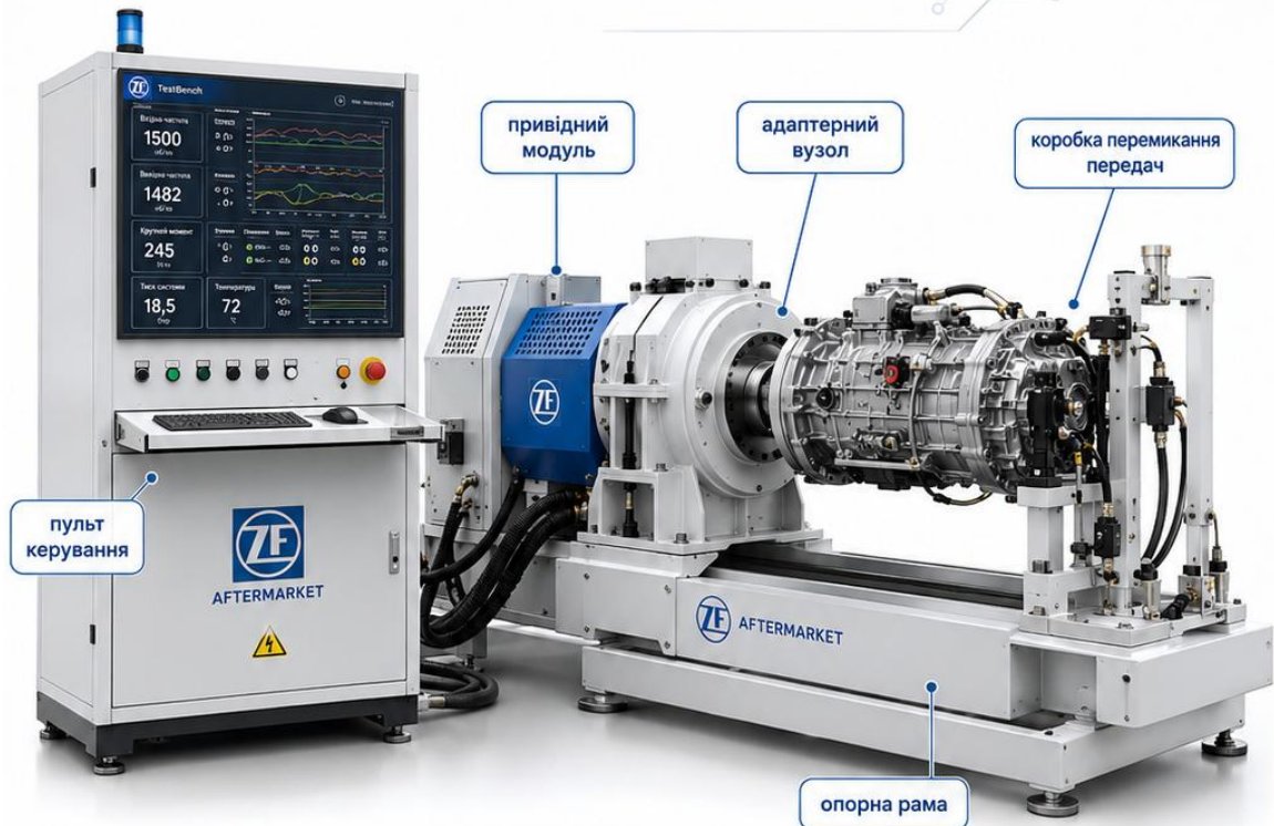
Рисунок 3.4 – Функціональний випробувальний стенд ZF Aftermarket для контролю коробок перемикавання передач.
