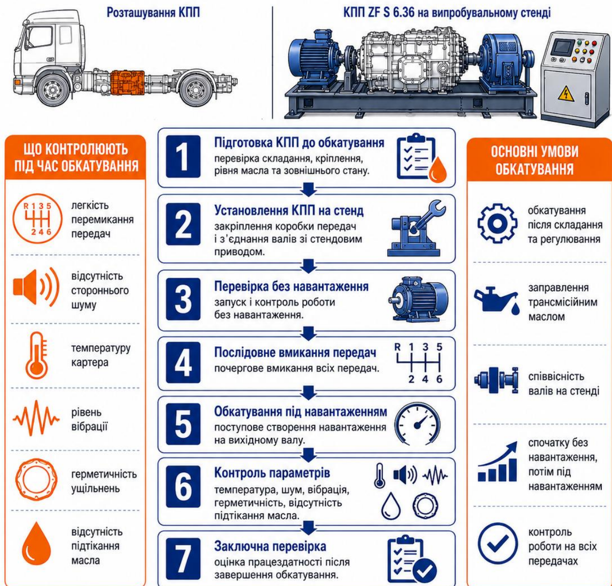
Рисунок 2.28 – Послідовність виконання технологічного процесу обкатування КПП ZF S 6.36.
