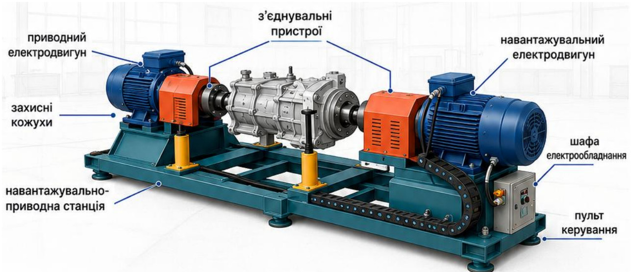
Рисунок 3.2 – Універсальний стенд КОПИС КС-02 для обкатування та випробування коробок перемикання передач
