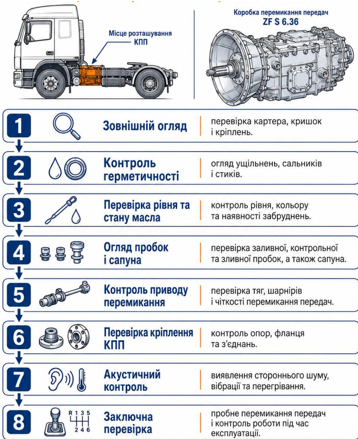
Рисунок 2.26 – Послідовність технічного обслуговування коробки перемикання передач ZF S 6.36.
