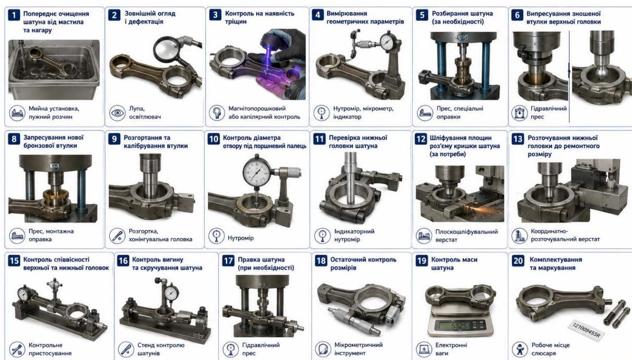
Рисунок 2.1 – Технологічний процес відновлення шатуна автомобіля
