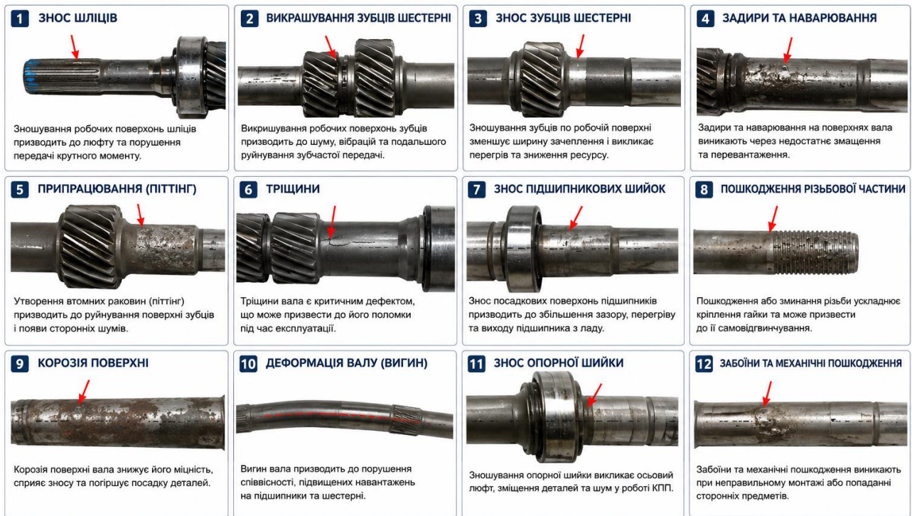
Рисунок 2.1 – Дефекти первинного валу автомобіля FORD FOCUS II
