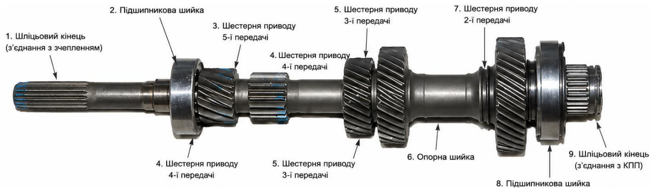
Рисунок 1.1 – Загальний вигляд первинного валу автомобіля FORD FOCUS II
