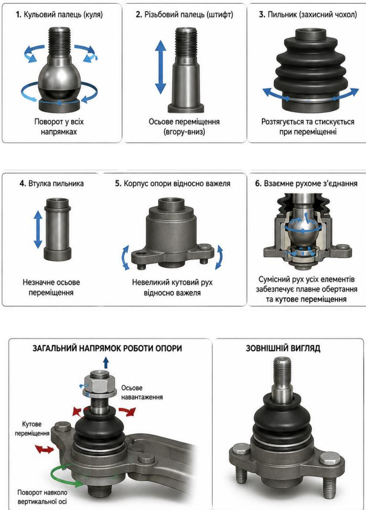
Рисунок 2.2 – Зовнішній вигляд кульової опори MEYLE 116 010 0043 автомобіля MAN TGE із вказанням напрямів руху
