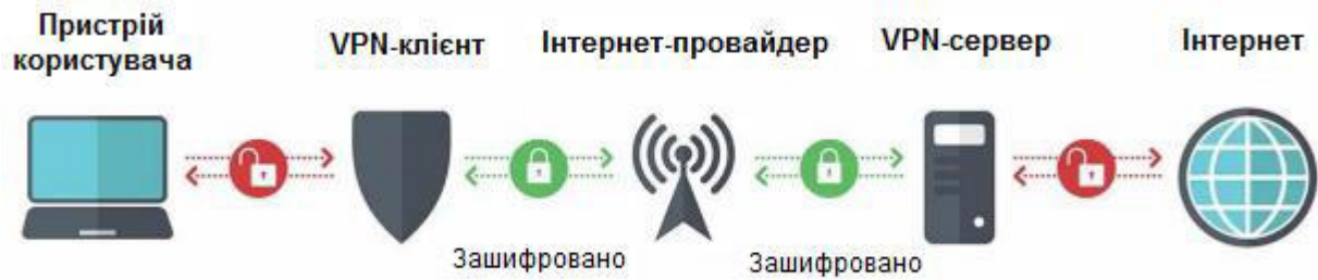
Рисунок 1.5 – Принцип роботи VPN
