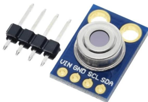
Рисунок 2.3 – Безконтактний інфрачервоний датчик температури MLX90614
