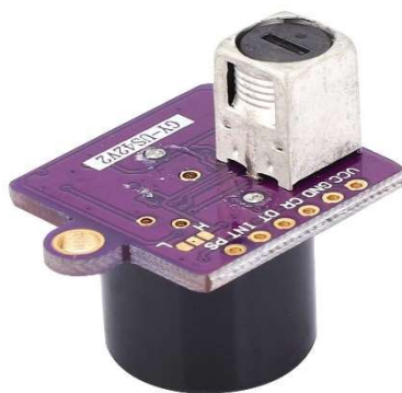
Рисунок 2.6 – Ультразвуковий сенсор GY-US42
