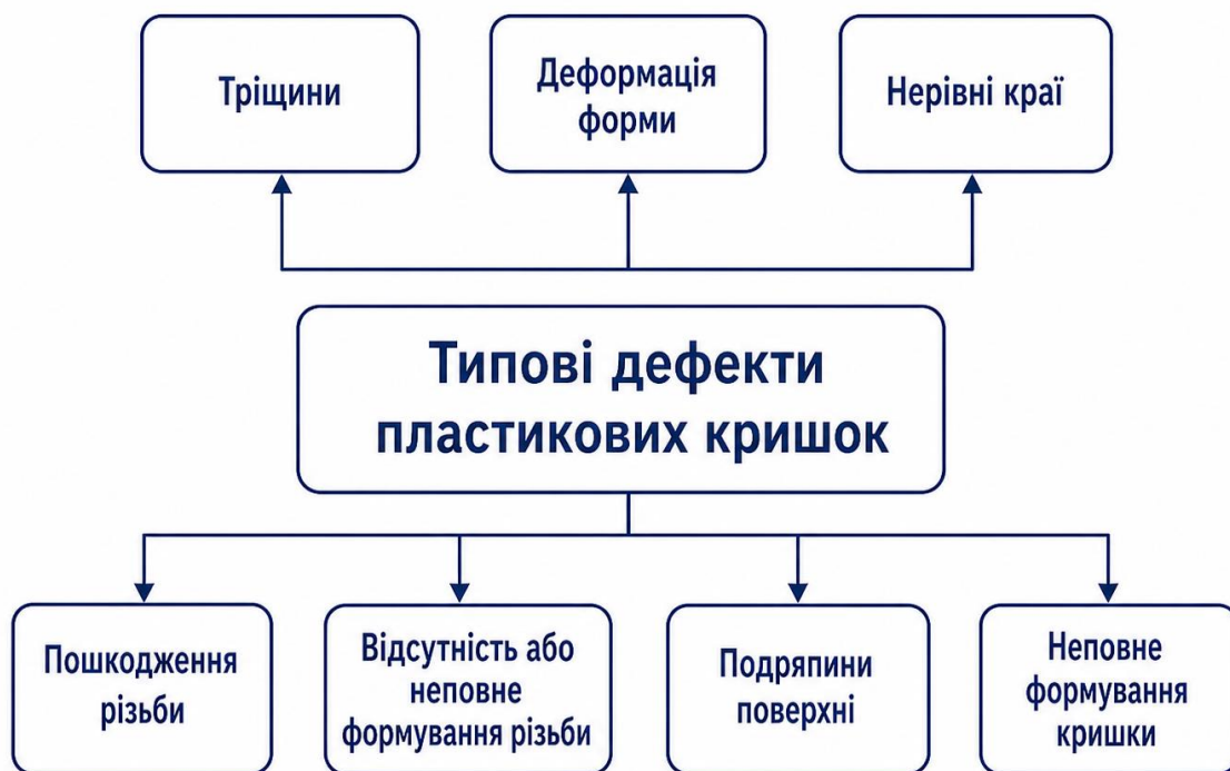
Рисунок 1.3 – Типові дефекти пластикових кришок
