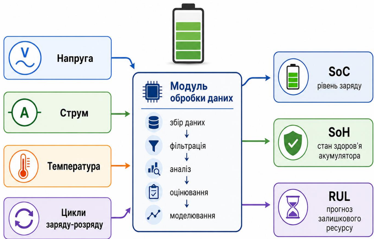
Рисунок 2.1 – Взаємозв’язок параметрів моніторингу та показників стану акумулятора
