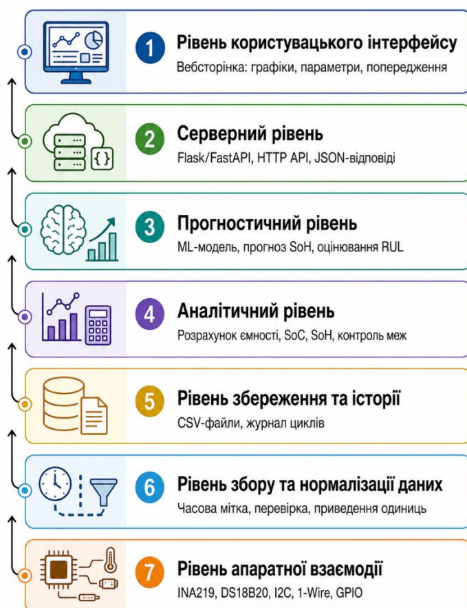
Рисунок 3.1 – Багаторівнева архітектура програмного забезпечення моніторингу стану акумуляторів з прогнозуванням їх деградації
