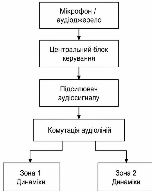
Рисунок 1.2 – Типова структура традиційної аналогової системи локального мовлення
