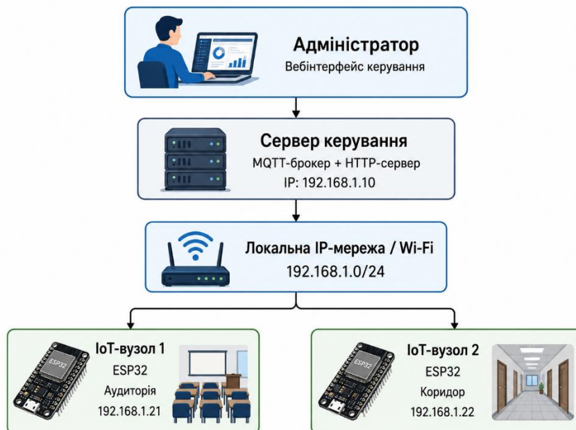
Рисунок 2.7 – Структура мережевого підключення та зонування системи локального мовлення
