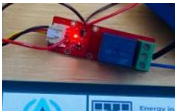
Рисунок 3.6 – Підключення релейного модуля для керування навантаженням
