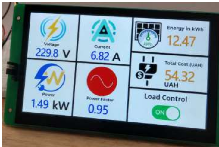
Рисунок 3.5 – Відображення параметрів енергоспоживання на НМІ-дисплеї
