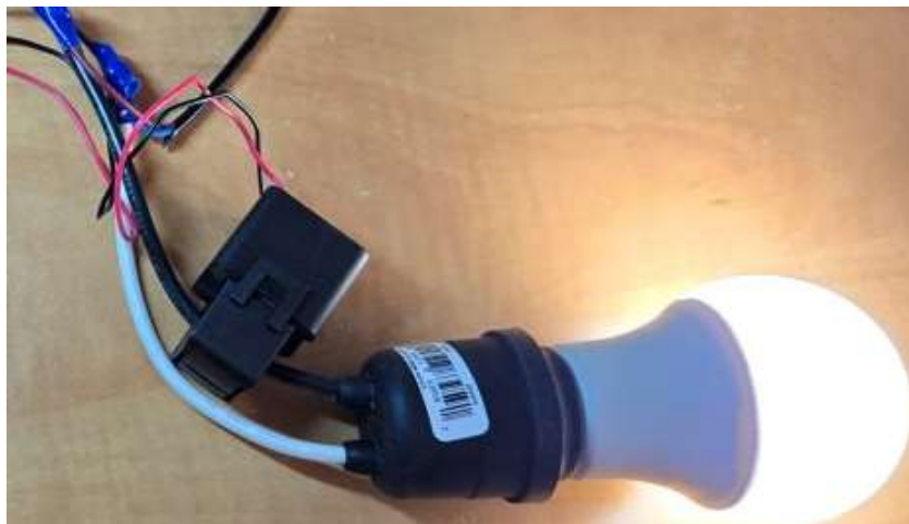
Рисунок 3.4 – Встановлення трансформатора струму PZCT-02 на фазний провідник навантаження
