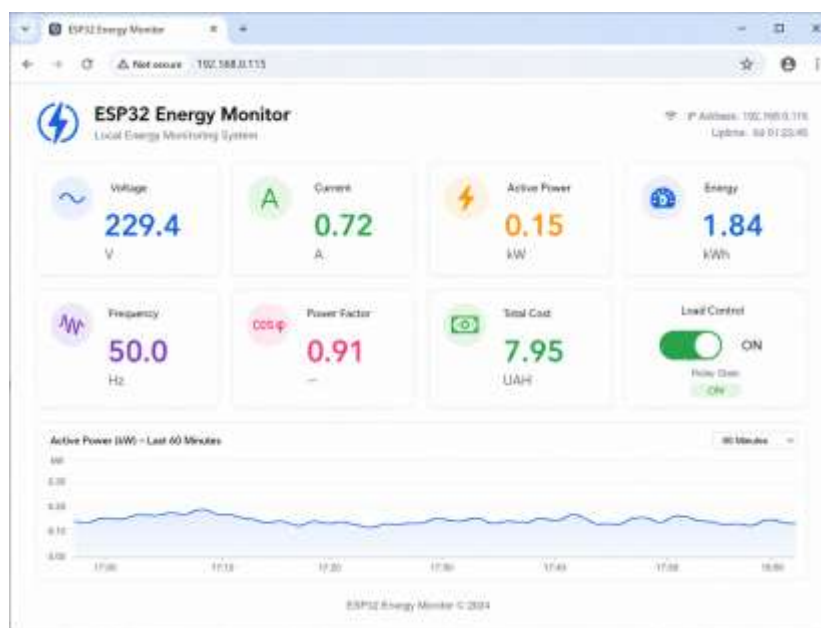
Рисунок 3.7 – Сторінка локального вебінтерфейсу ESP32
