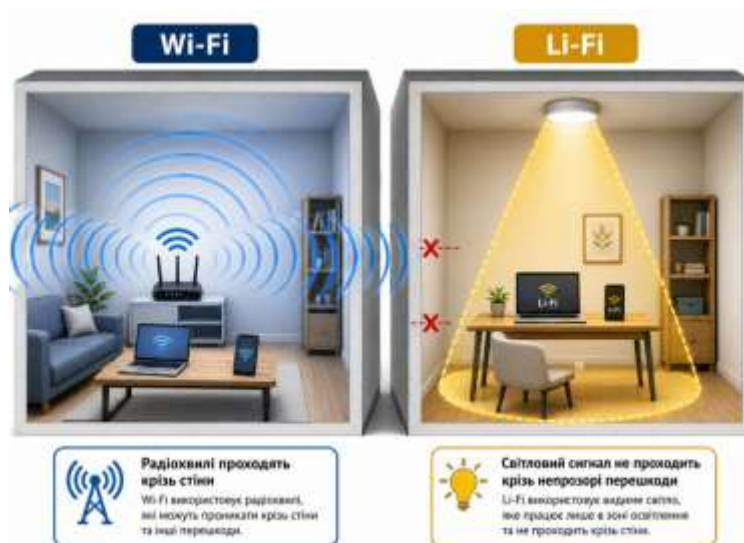
Рисунок 1.6 – Порівняння поширення сигналів Wi-Fi та Li-Fi у приміщенні
