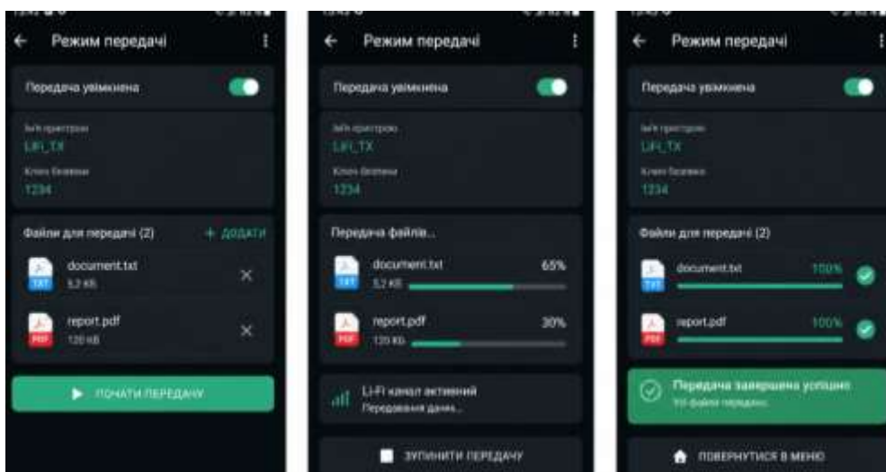
Рисунок 3.16 – Передавання файлів через Li-Fi канал та відображення статусу передачі
