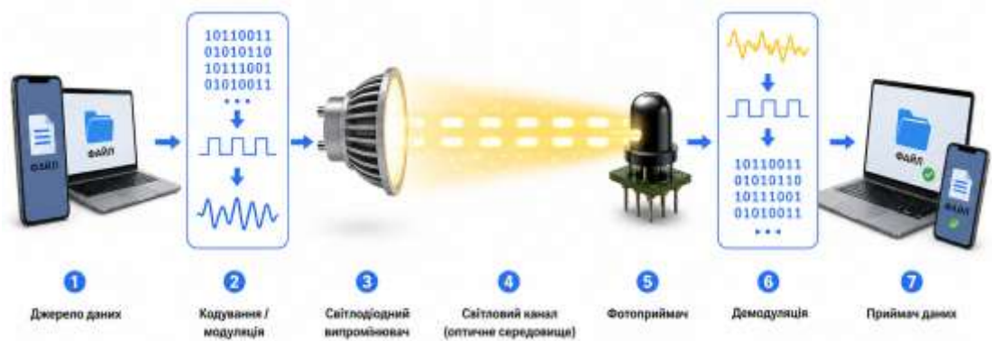
Рисунок 1.3 – Загальний принцип роботи технології Li-Fi
