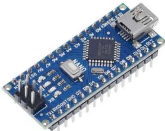
Рисунок 2.2 – Плата Arduino Nano
