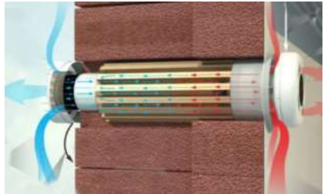
Рисунок 1.6 – Рекуператор з мідним теплообмінником
