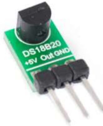
Рисунок 2.5 - Датчик температури DS18B20
