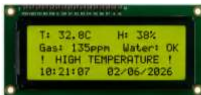
Рисунок 3.5 – Повідомлення про перевищення допустимої температури.
