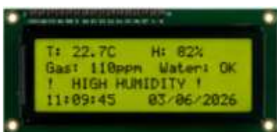
Рисунок 3.6 – Повідомлення про перевищення допустимого рівня вологості.
