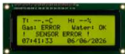
Рисунок 3.13 – Повідомлення про помилку роботи датчика.
