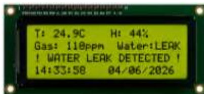
Рисунок 3.8 – Повідомлення про виявлення протікання води.
