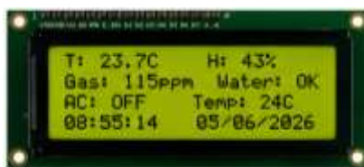
Рисунок 3.10 – Відображення стану системи після відключення кондиціонера.
