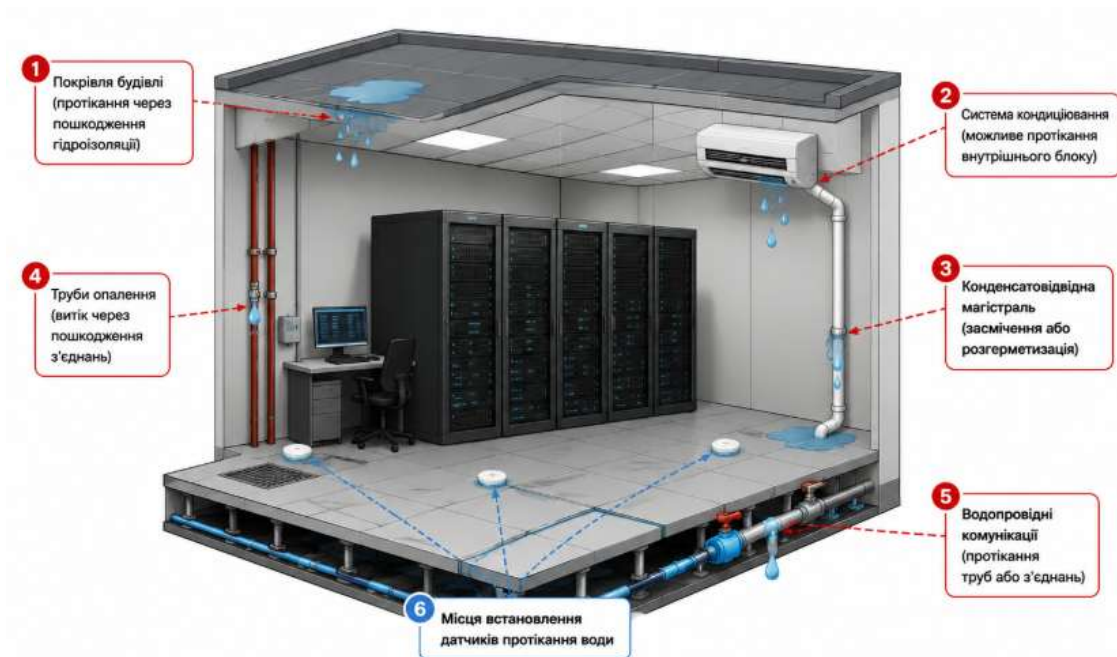
Рисунок 1.5 – Основні джерела потрапляння води до серверного приміщення
