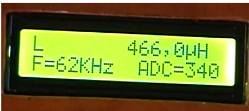
Рисунок 3.19 – Вимірювання SMD-дроселя номіналом 470 мкГн
