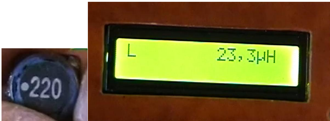
Рисунок 3.18 – Вимірювання SMD-дроселя 22 мкГн
