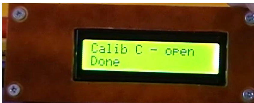
Рисунок 3.10 – Завершення калібрування режиму вимірювання ємності
