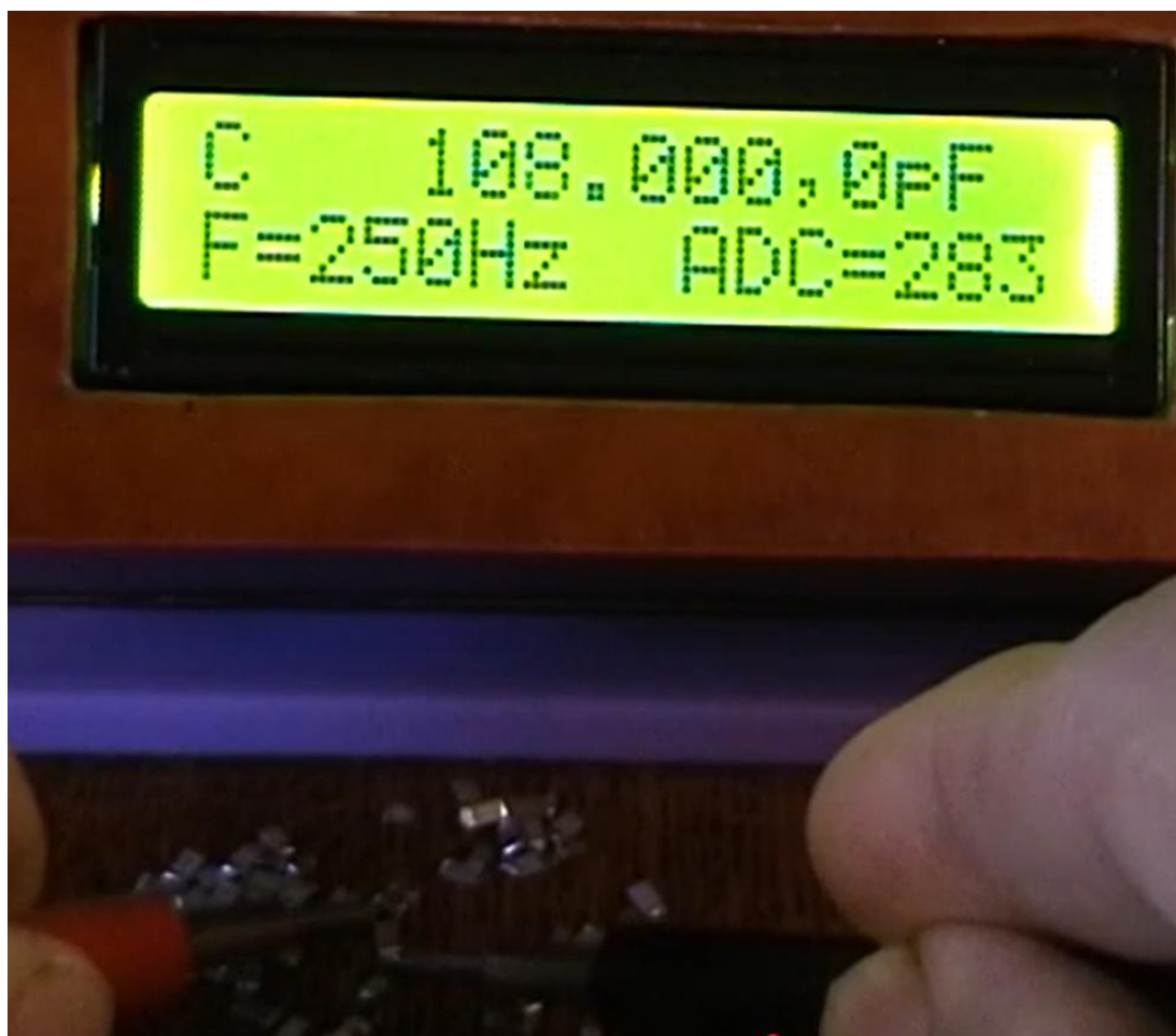
Рисунок 3.13 – Вимірювання SMD-конденсатора номіналом 100 нФ
