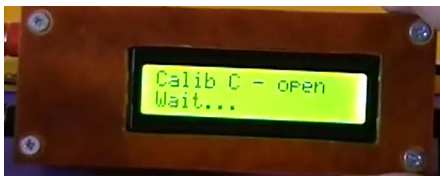
Рисунок 3.9 – Початок калібрування режиму вимірювання ємності
