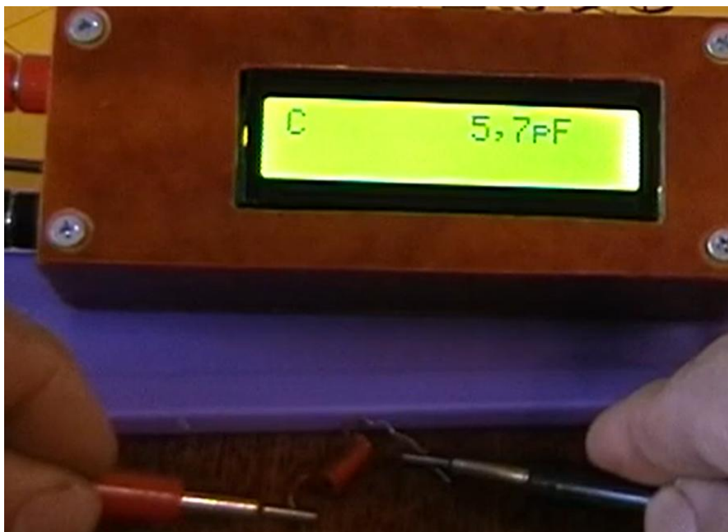
Рисунок 3.11 – Вимірювання ємності конденсатора за допомогою щупів
