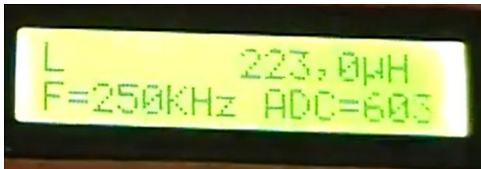
Рисунок 3.16 – Вимірювання індуктивності 224 мкГн
