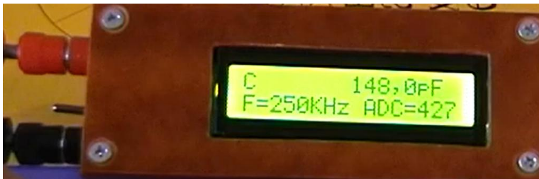
Рисунок 3.12 – Вимірювання конденсатора номіналом 150 пФ
