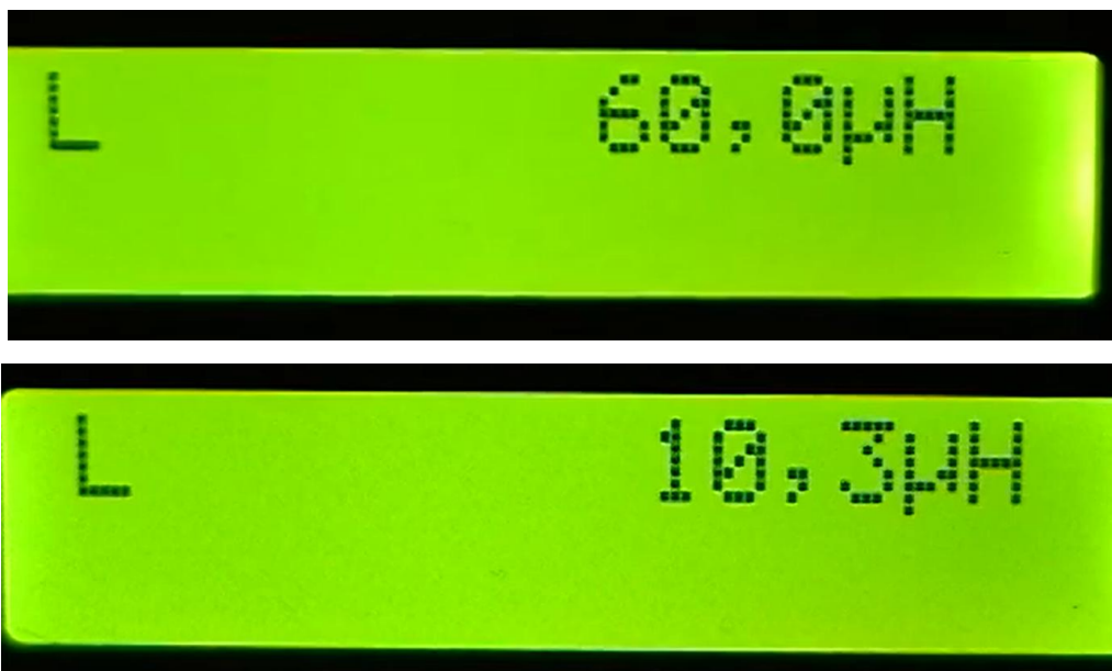
Рисунок 3.17 – Вимірювання індуктивностей 60 мкГн та 10 мкГн
