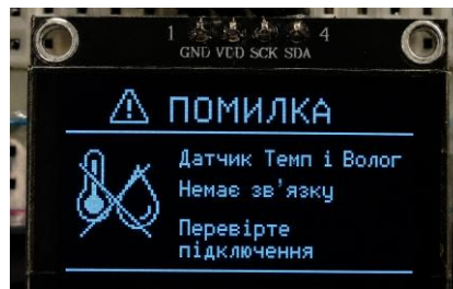
Рисунок 3.14 – Повідомлення про помилку підключення датчика температури та вологості
