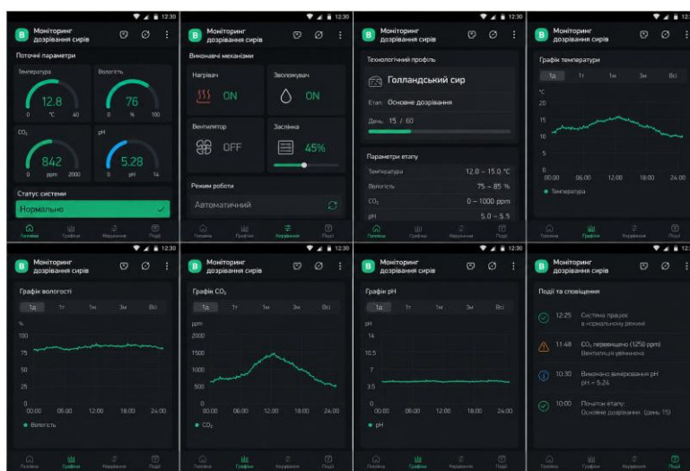
Рисунок 3.6 – Відображення параметрів системи у мобільному застосунку Blynk
