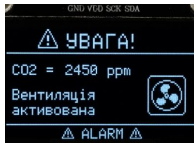
Рисунок 3.13 – Аварійне повідомлення при перевищенні концентрації CO 2
