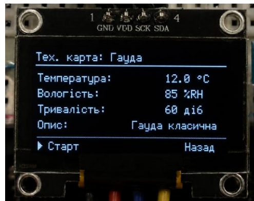
Рисунок 3.9 – Перегляд технологічної карти сиру та запуск процесу
