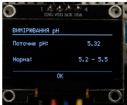
Рисунок 3.11 – Екран періодичного вимірювання кислотності рН
