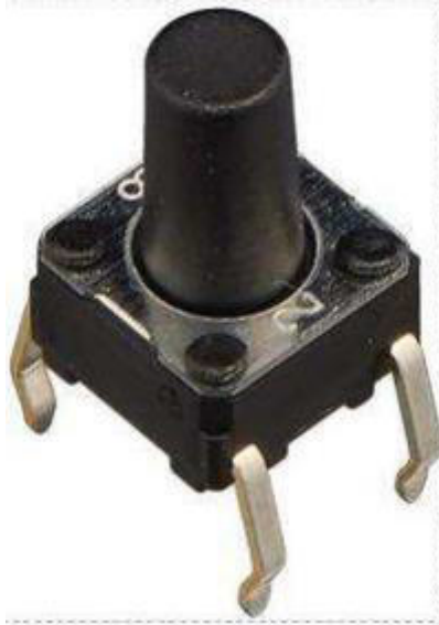
Рисунок 2.7 – Зовнішній вигляд тактової кнопки V3F-1070
