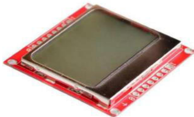
Рисунок 2.9 – Загальний вигляд дисплея Nokia 5110
