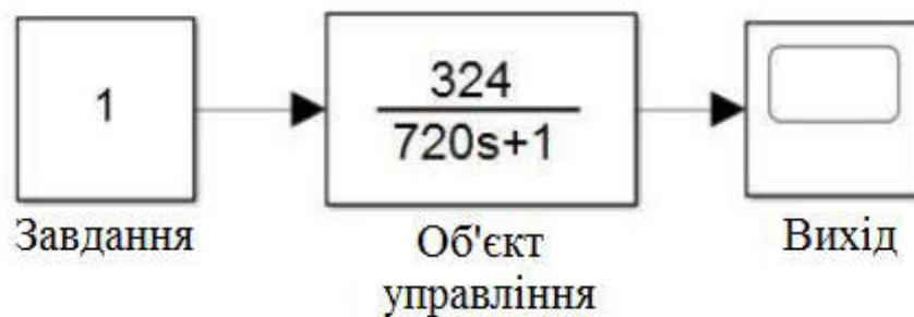
Рисунок 3.4 – Схема під'єднання об'єкта керування
