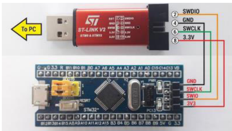
Рисунок 2.5 – Під'єднання програматора до налагоджувальної плати
