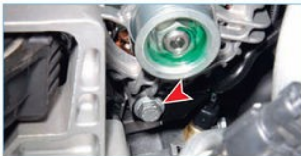
Рисунок 2.1 – Нижнє кріплення генератора
