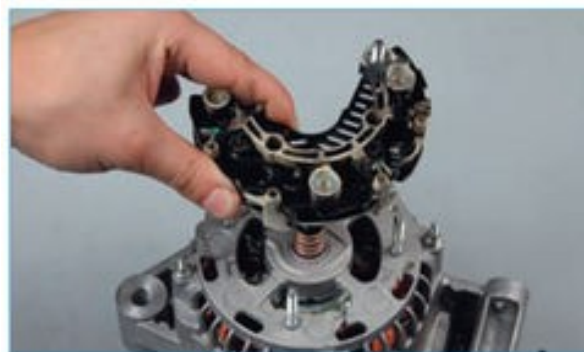
Рисунок 2.9 – Зняття випрямного блоку
