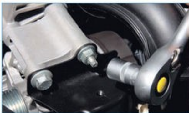
Рисунок 2.2 – Верхнє кріплення генератора
