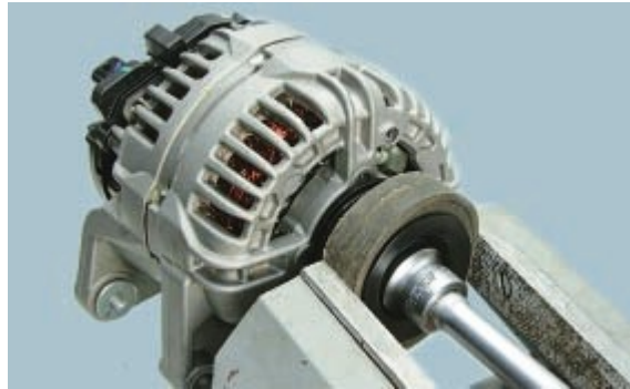
Рисунок 2.5 – Відкручування/закручування гайки кріплення шківів
