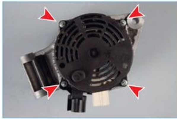
Рисунок 2.7 – Зняття регулятора напруги:
