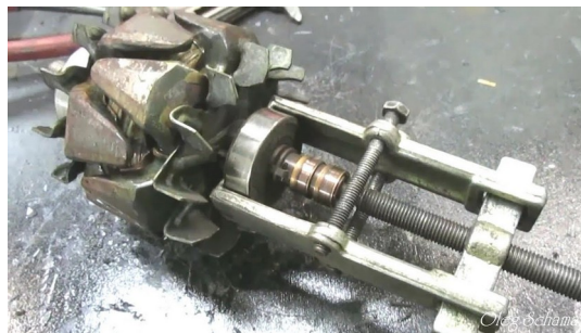
Рисунок 2.11 – Зняття заднього підшипника
