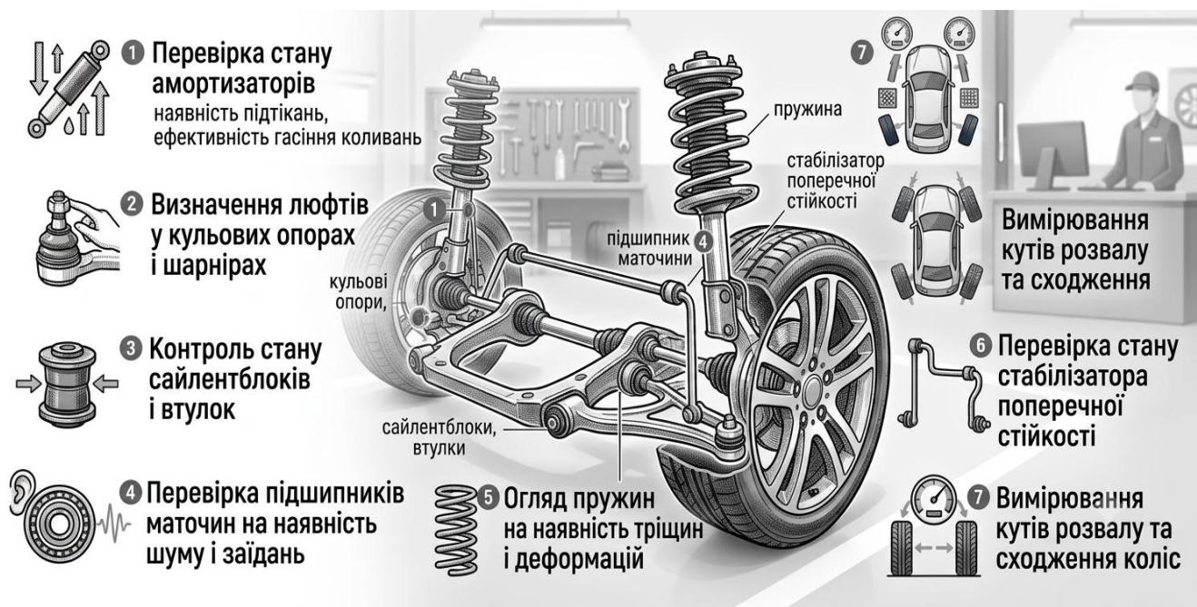
Рисунок 2.4 – Основні діагностичні операції передньої підвіски
