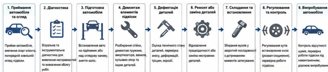
Рисунок 2.3 – Послідовність виконання технологічного процесу ремонту передньої підвіски
