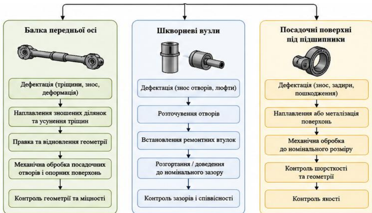
Рисунок 2.4 – Технологічні схеми відновлення основних деталей передньої осі
