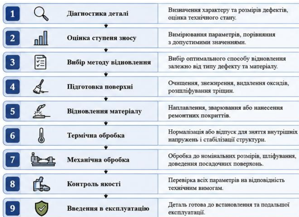
Рисунок 2.3 – Деталізований технологічний маршрут відновлення
