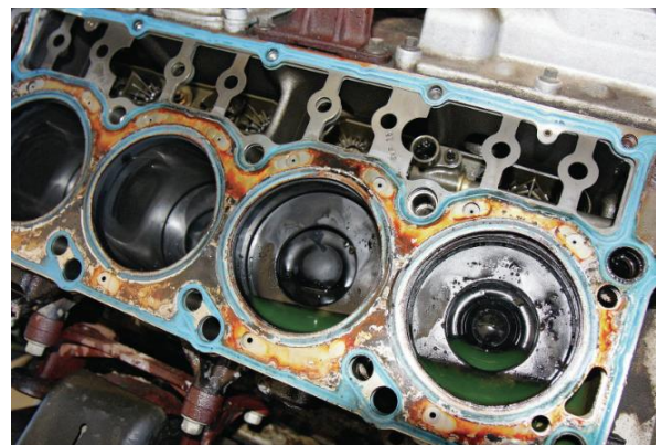
Рисунок 1.7 – Пошкоджена прокладка головки блока.
