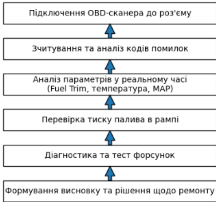
Рисунок 1.10 – Алгоритм діагностики системи впорскування двигуна Lifan Smily/320.
