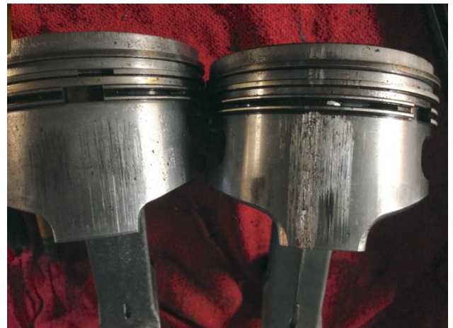
Рисунок 1.5 – Задири на поверхні циліндра та поршня.
