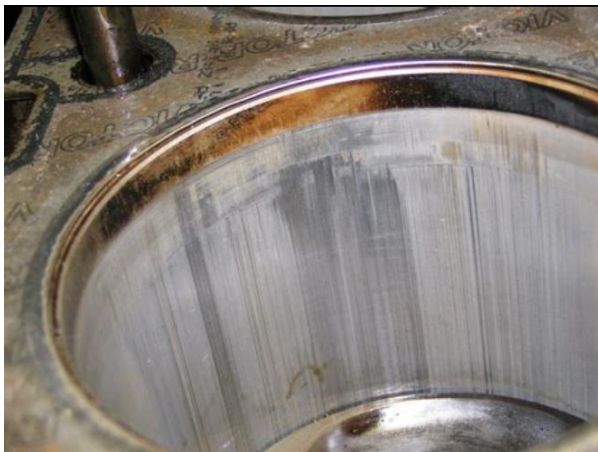
Рисунок 1.5 – Задири на поверхні циліндра та поршня.
