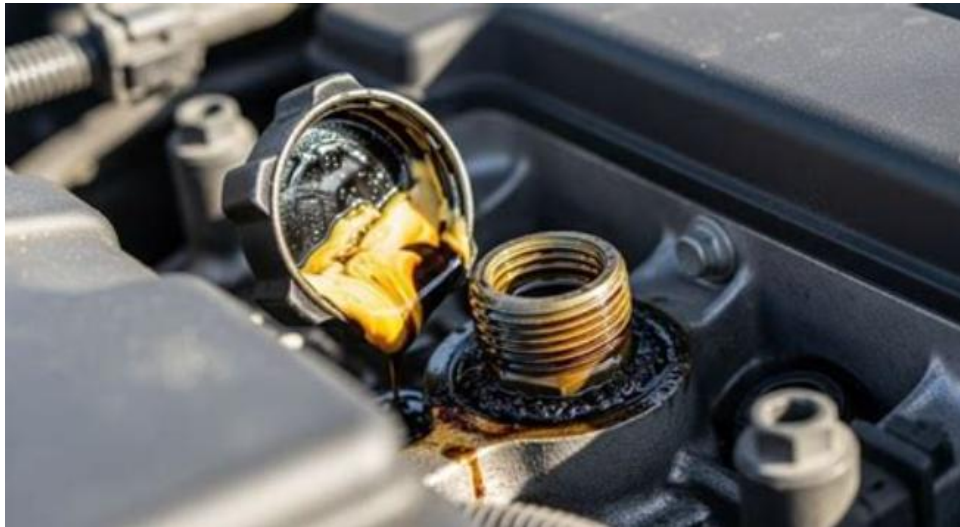
Рисунок 1.8 – Емульсія під кришкою мастила або на масляному щупі.
