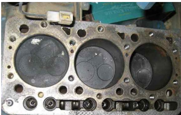
Рисунок 1.7 – Пошкоджена прокладка головки блока.
