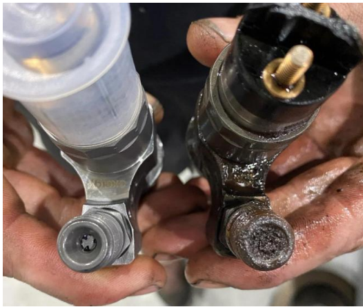
Рисунок 1.6 – Забруднена форсунка з відкладеннями на розпилювачі.
