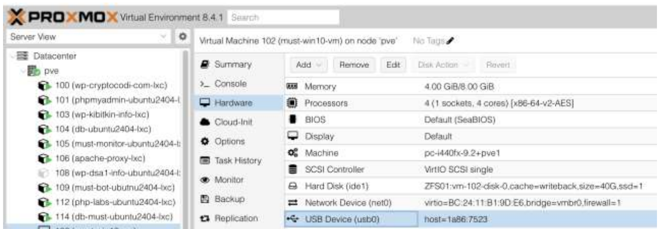
Рисунок 1.3 – Підключення інвертора Must до віртуальної машини
