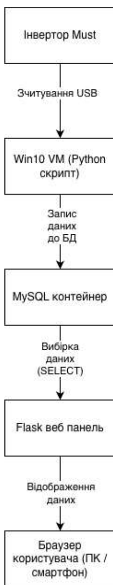
Рисунок 2.2 – Логічна схема обміну даними в системі моніторингу інвертора Must
