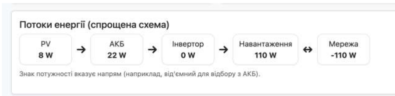
Рисунок 3.8 – Схема потоків енергії у веб-панелі
