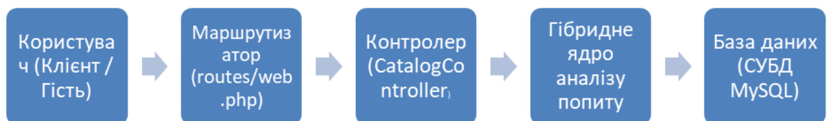
Рисунок 3.7 – Схема взаємодії компонентів гібридної рекомендаційної моделі
