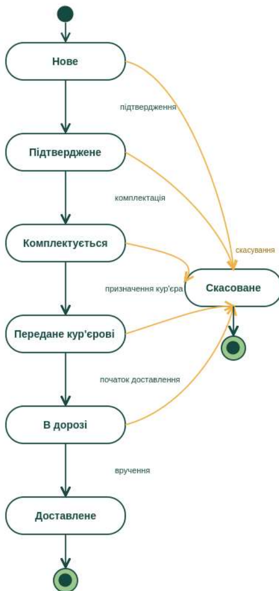
Рисунок 2.8 – Діаграма станів життєвого циклу замовлення в вебплатформі для відстеження товарів
