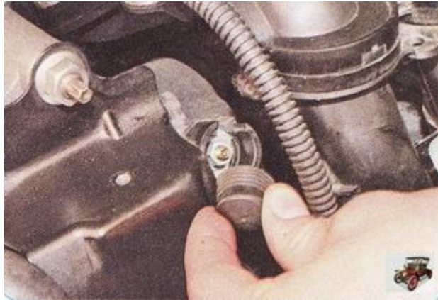
Рисунок 2.3 – Зняття захисного ковпачка
