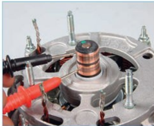
Рисунок 2.17 – Перевірка обриву в обмотці ротора
