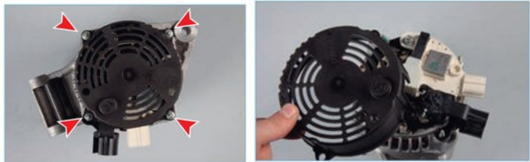
Рисунок 2.9 – Зняття задньої кришки генератора
