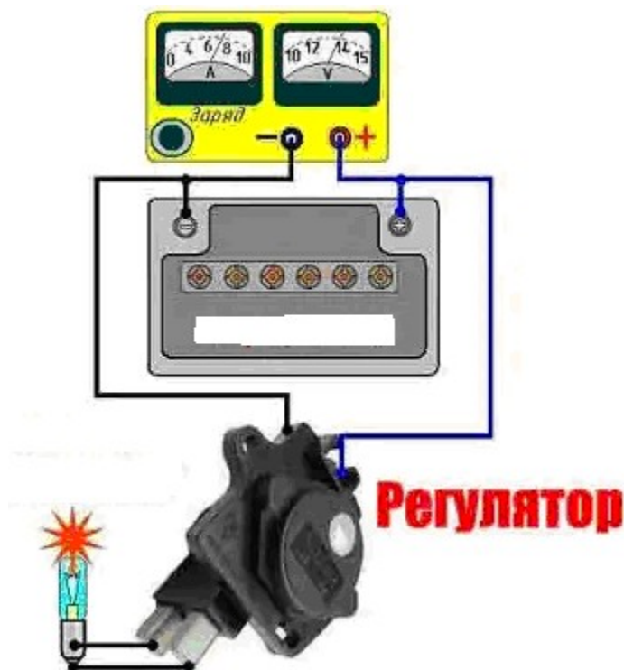
Рисунок 2.21 – Схема для перевірки регулятора напруги: 1 –регулятор напруги; 2 – акумулятор; 3 – трансформатор; 4 – контрольна лампа.
