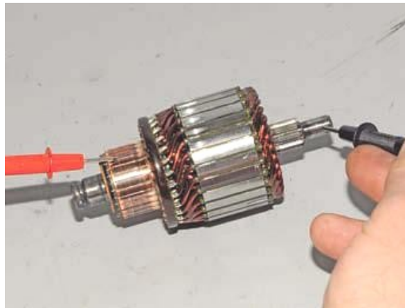
Рисунок 2.26 – Перевірка якоря омметром
