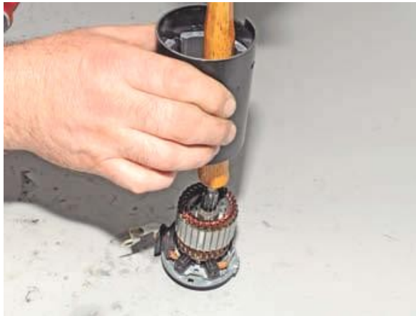
Рисунок 2.27 – Встановлення корпусу на якір
