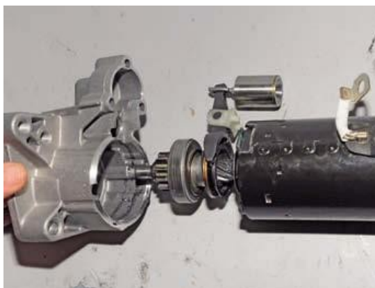
Рисунок 2.12 – Від'єднання передньої кришки
