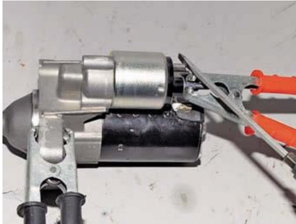
Рисунок 2.3 – Перевірка роботи здатності стартера
