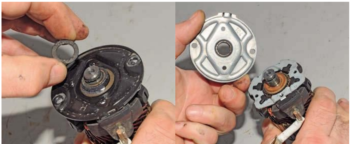
Рисунок 2.17 – Зняття задньої кришки стартера
