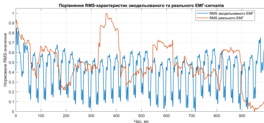
Рисунок 3.14 – Порівняння RMS-характеристик змодельованого та реального ЕМГ-сигналів
