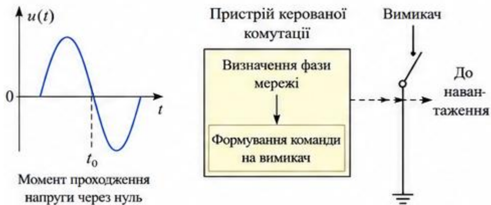
Рисунок 2.6 – Принцип реалізації керованої комутації
