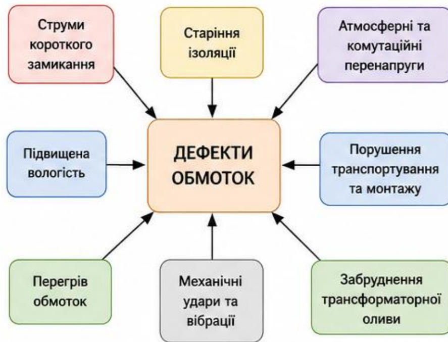
Рисунок 1.8 – Основні причини виникнення дефектів обмоток силового трансформатора
