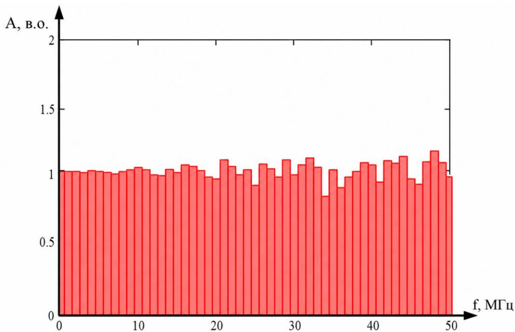
Рисунок 3.6 – Відношення АЧХ справної обмотки.
