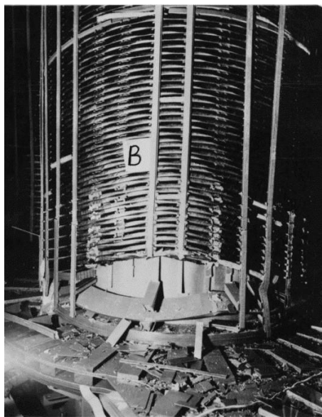
Рисунок 1.6 – Приклад аксіального зміщення обмоток трансформатора
