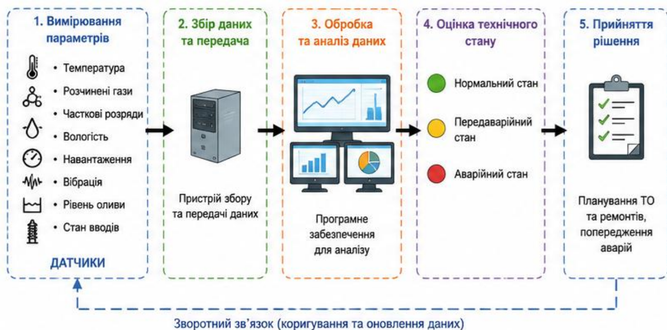
Рисунок 1.3 – Загальна структура системи контролю трансформатора
