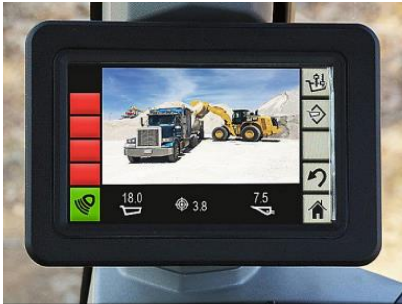
Рисунок 1.2 – Інтерфейс системи «Caterpillar Cat Detect Safety»
