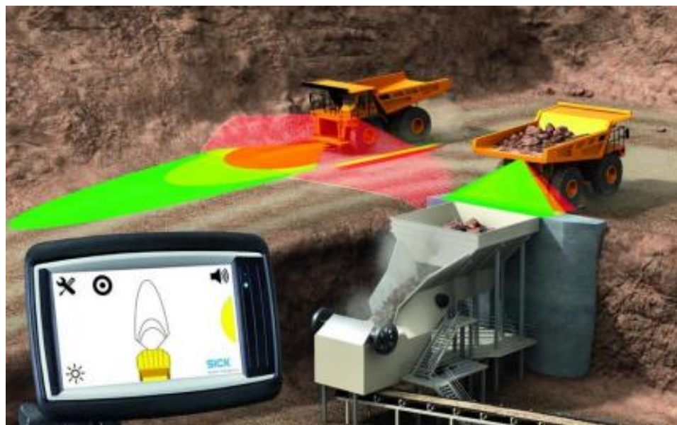
Рисунок 1.1 – Ілюстрація принципу роботи "SICK Safety Collision Prevention"
