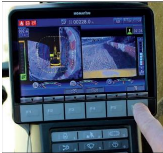
Рисунок 1.3 – Інтерфейс системи «Komatsu Intelligent Machine Control»
