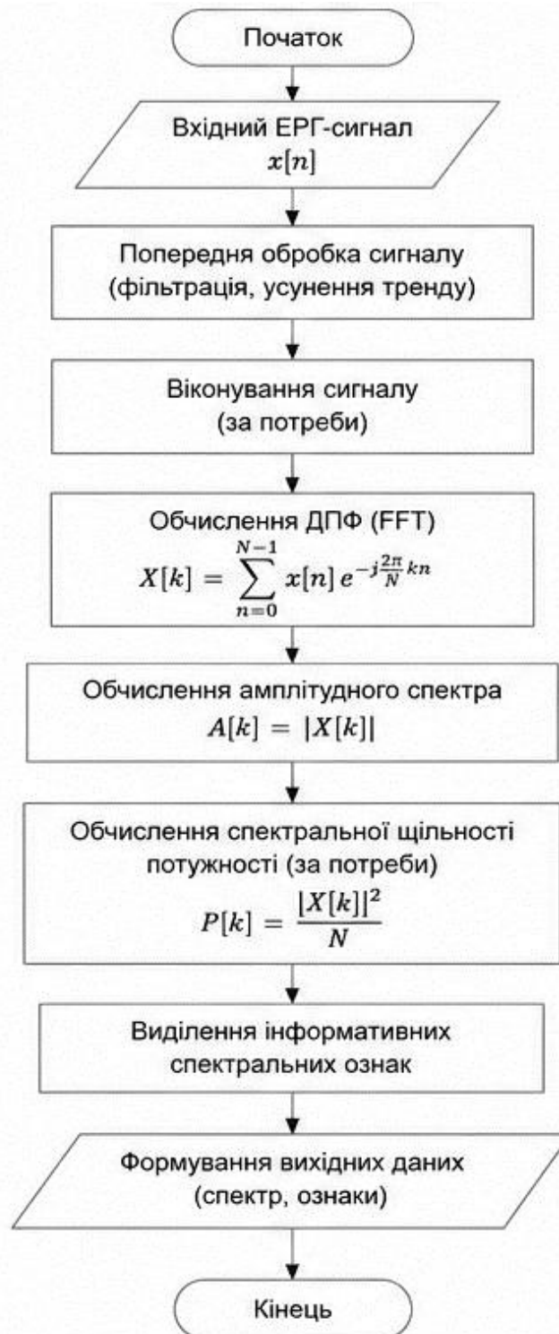
Рисунок 2.10 – Блок-схема алгоритму спектральної обробки ЕРГ-сигналу
