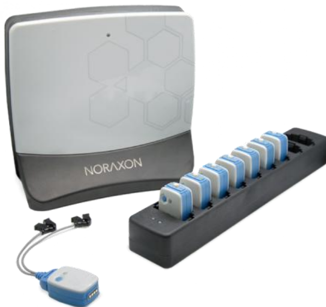
Рисунок 1.7 – Система реєстрації та комп'ютерної обробки ЕМГ-сигналів Noraxon Ultium EMG [15]
