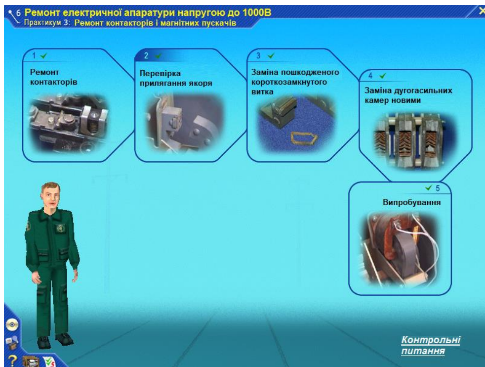
Рисунок 3.38 – Модуль «Ремонт електричної апаратури напругою до 1 кВ»: ремонт контакторів і магнітних пускачів
