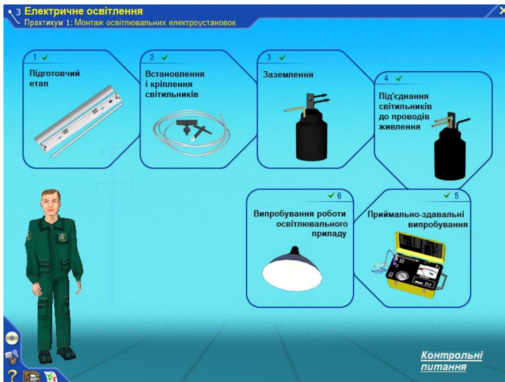
Рисунок 3.13 – Модуль «Електричне освітлення»: монтаж освітлювальних електроустановок
