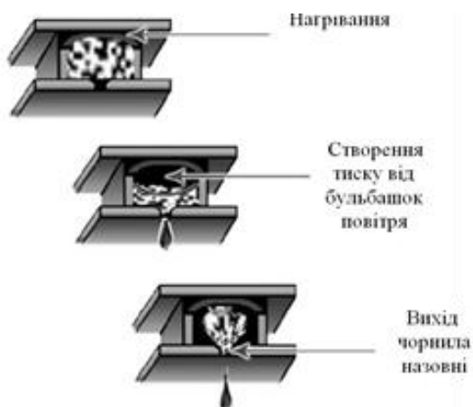
Рисунок 1.4 – Бульбашковий струменевий друк
