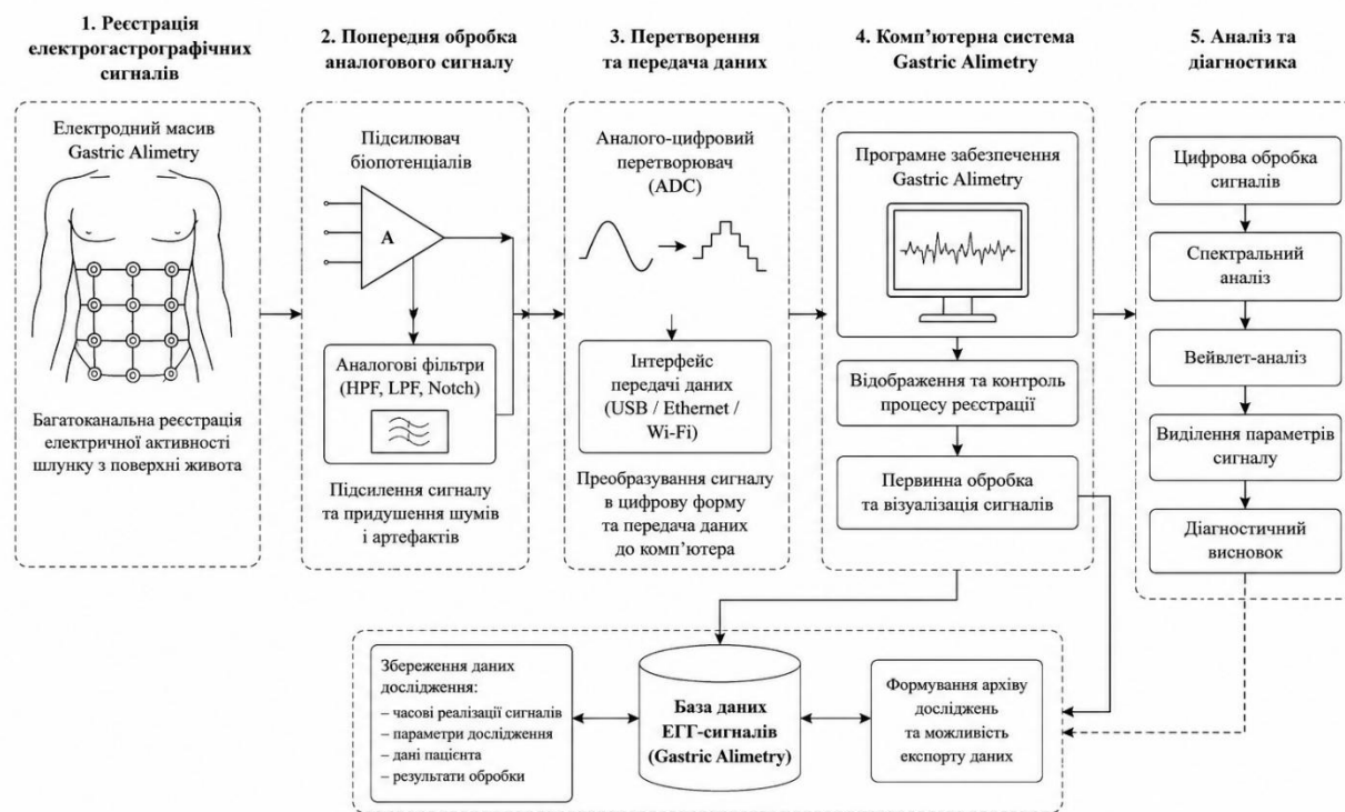
Рисунок 2.2 – Структурна схема комп'ютерної системи Gastric Alimetry
