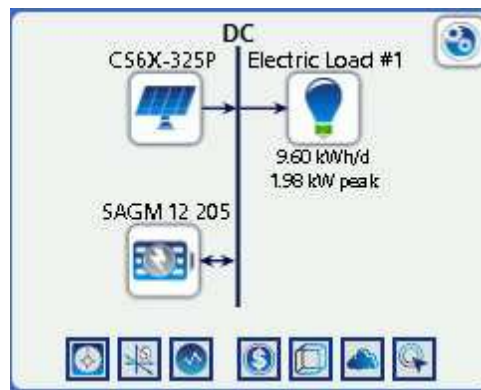
Рисунок 2.13 - Схематична діаграма запропонованої фотоелектричної системи з акумуляторною батареєю
