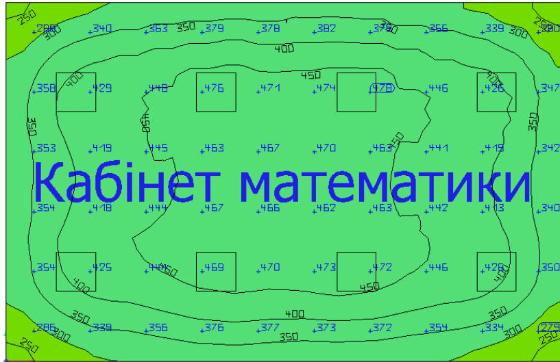
Рисунок 2.10 – Ізолюкси на робочій поверхні кабінету математики
