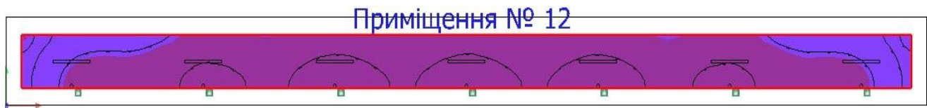
Рисунок 2.19 – Ізолінії аварійної освітленості в приміщенні коридору № 3
