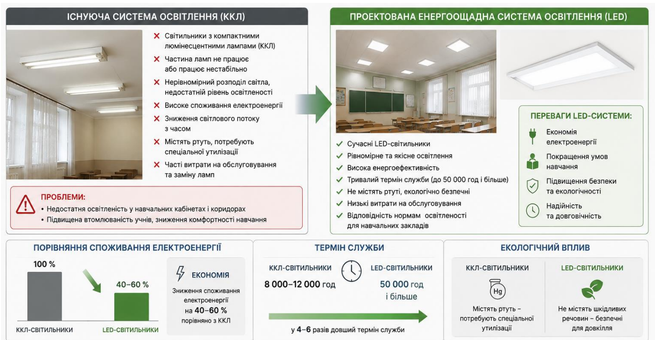
Рисунок 1.7 – Порівняльна характеристика систем освітлення на базі КЛЛ та LED-світильників
