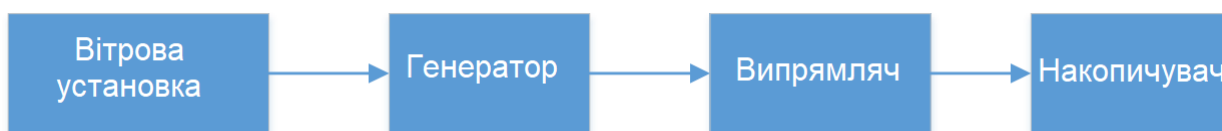
Рисунок 2.3 – Блок-схема алгоритму з генератором, що обертається з постійною частотою
