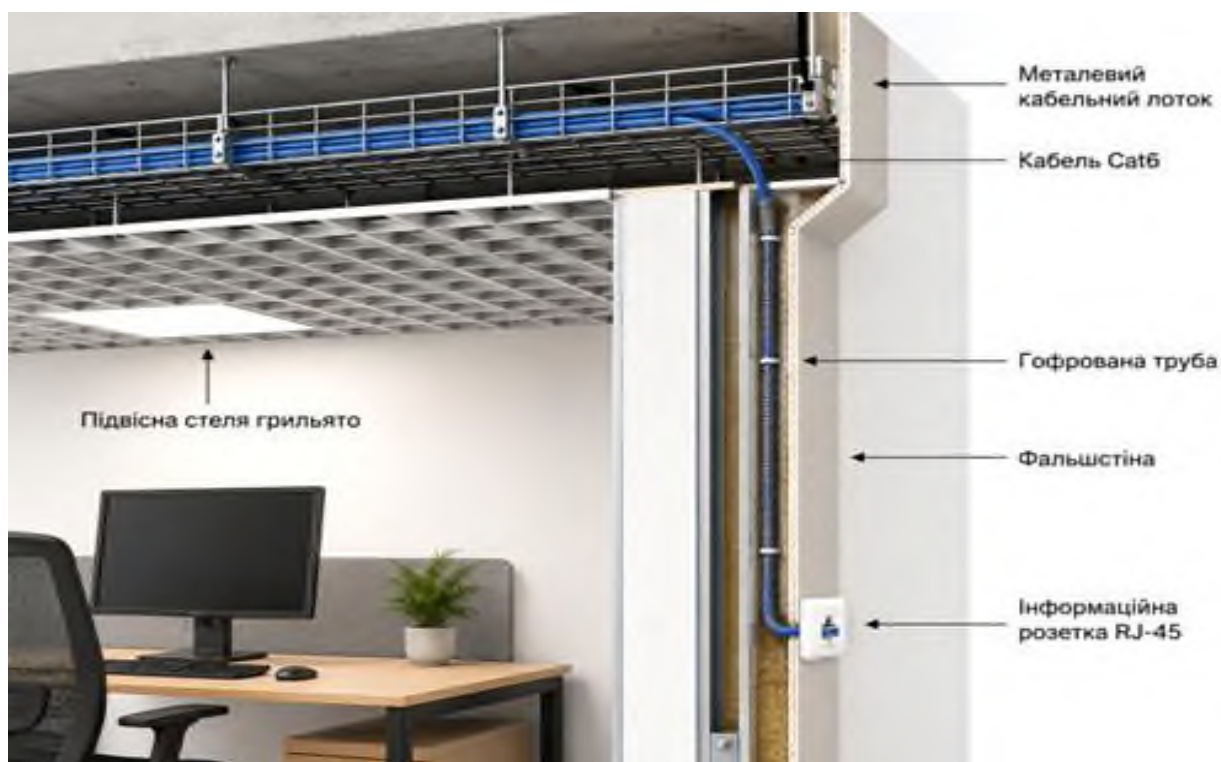
Рисунок 2.3 – Особливості монтажу кабельної мережі
