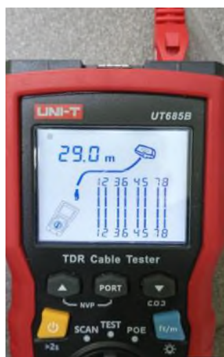
Рисунок 3.7 – Результат перевірки кросування кабельної лінії та її довжини
