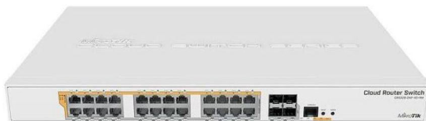
Рисунок 2.8 – Комутатор MikroTik CRS328-24P-4S+RM
