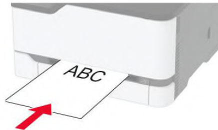
Рисунок 2.5 – Завантаження аркуша паперу стороною для друку вгору
