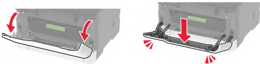
Рисунок 2.8 – Відкривання передніх дверцят
