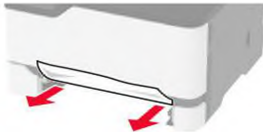
Рисунок 2.41 – Виймання зім'ятого паперу в стандартному лотку
