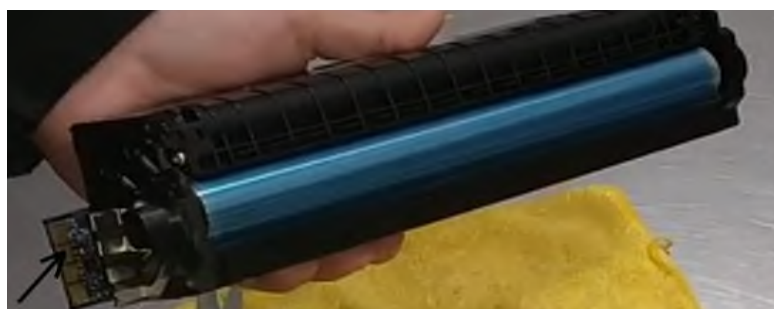
Рисунок 2.36 – Місце встановленого чипа
