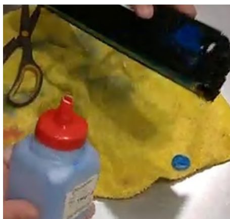
Рисунок 2.34 – Підведення банки до картриджа
