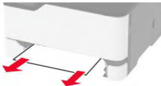
Рисунок 2.47 – Виймання зім'ятого паперу в пристрої ручної подачі
