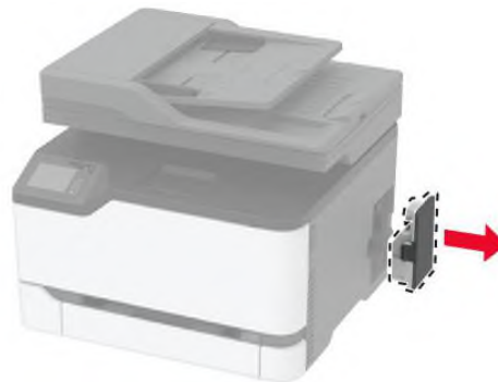
Рисунок 2.12 – Виймання ємності відпрацьованого тонера
