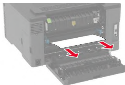
Рисунок 2.39 – Виймання зім'ятого паперу
