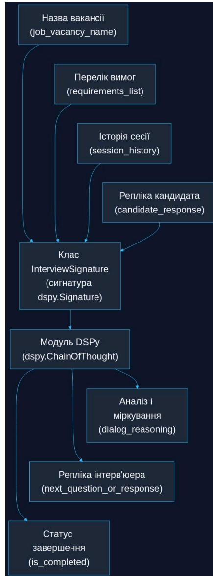
Рисунок 2.8 – Структура сигнатури та схема потоків даних діалогового агента
