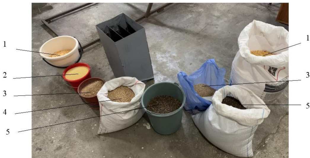
Рис. 3.5. Сипкі матеріали, що піддавались змішуванню шнековим конвеєром: зерна кукурудзи 1, проса 2, пшениці 3, гороху 4, гречки 5
