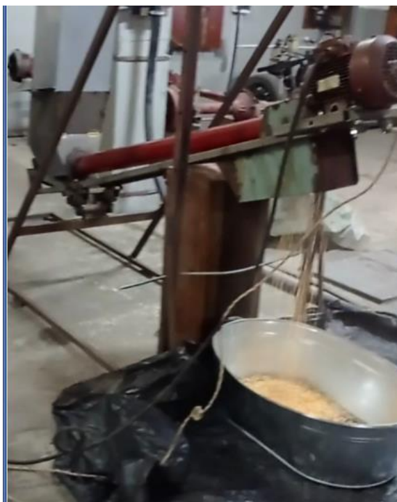
Рис. 3.8. Фрагмент процесу транспортування та змішування сипких матеріалів шнековим конвеєром
