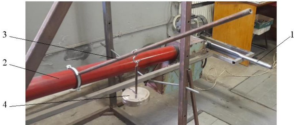
Рис. 3.10. Фото процесу визначення величини моменту тертя, що виникає між кожухом та матеріалом, що піддається транспортуванню та змішуванню шнековим конвеєром
