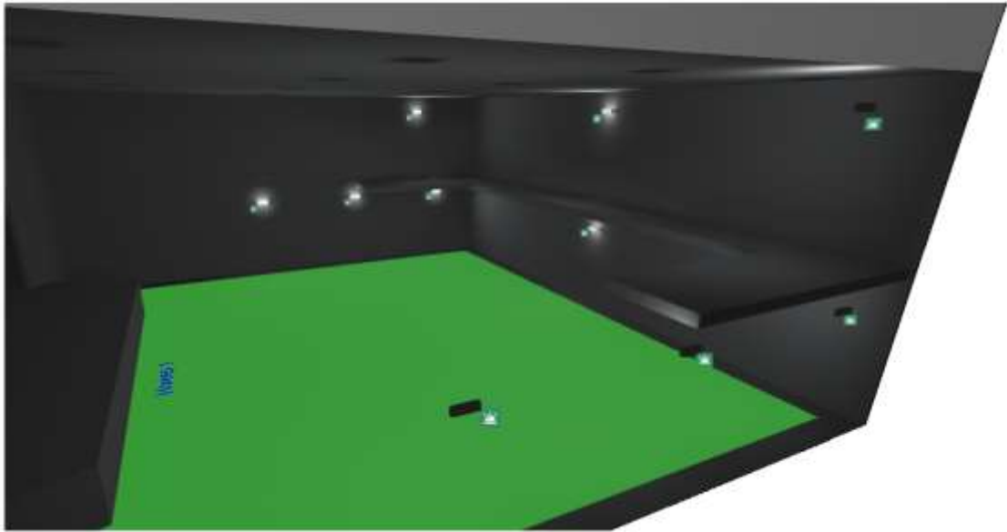
Рисунок 3.6 – Розміщення світильників аварійного освітлення глядацького залу з балконом
