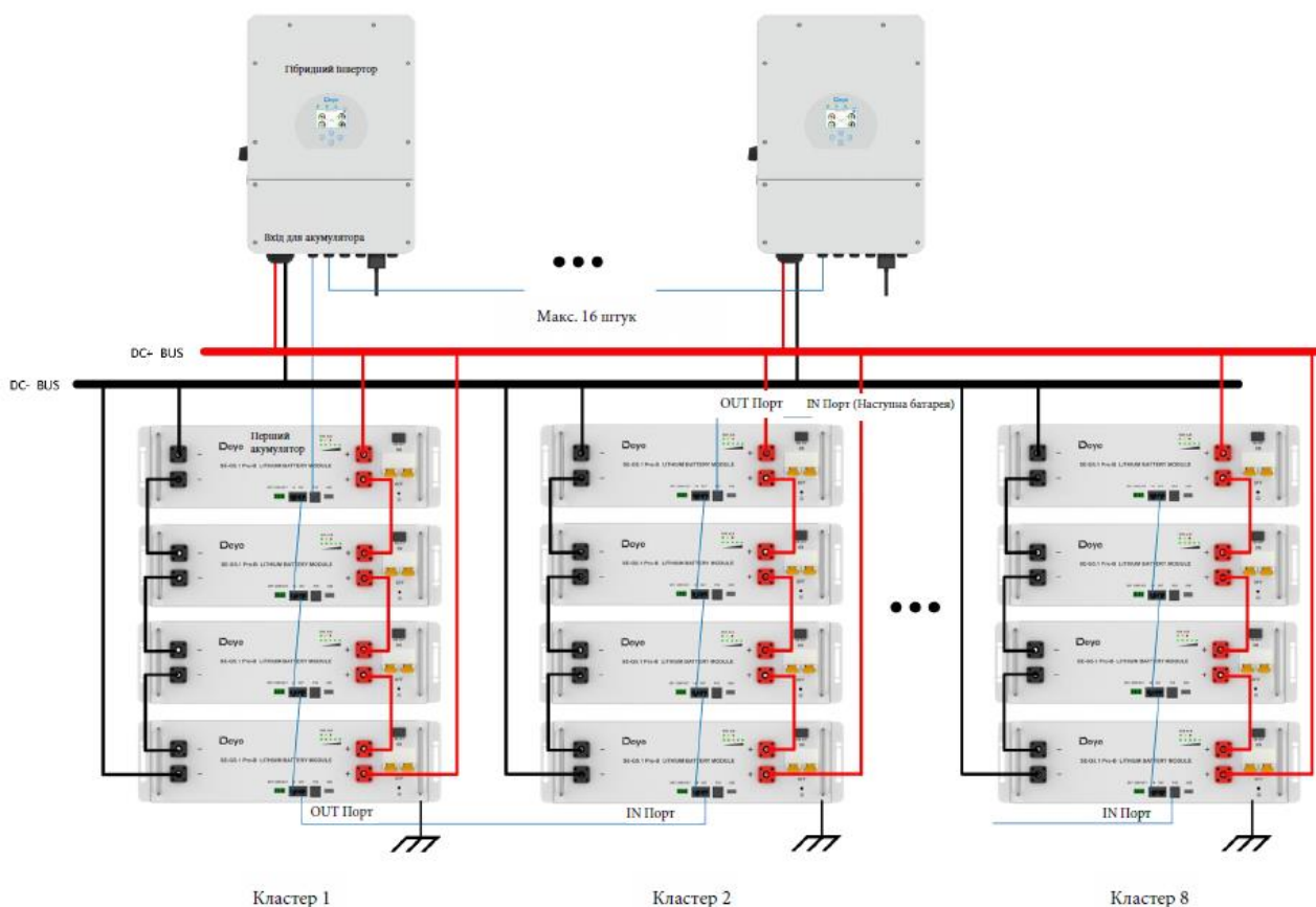
Рисунок 2.11 - Паралельний режим 2. Система більшої потужності.
